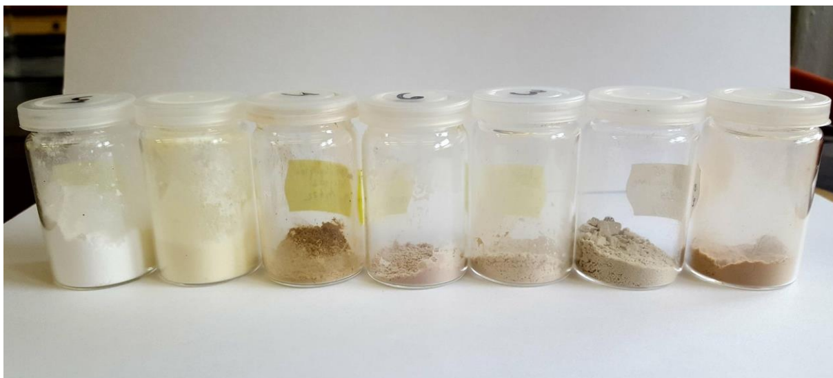
Zdjęcie 3. Nośniki krzemionkowe (pierwszy od lewej – „czysty” MCF, następnie sfunkcjonalizowany MCF, kolejne- osadzone na MCF kompleksy rutenu).
