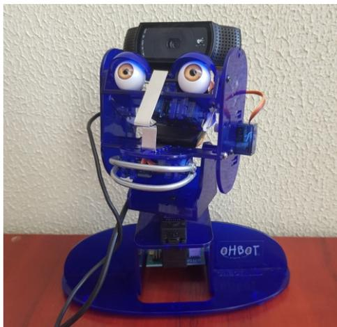
Rys. 1. Stanowisko robota społecznego *OhBot* z kamerą
