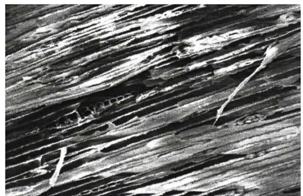
Węgiel drzewny, mikrostruktura wzdłuż włókien, powiększenie x200
