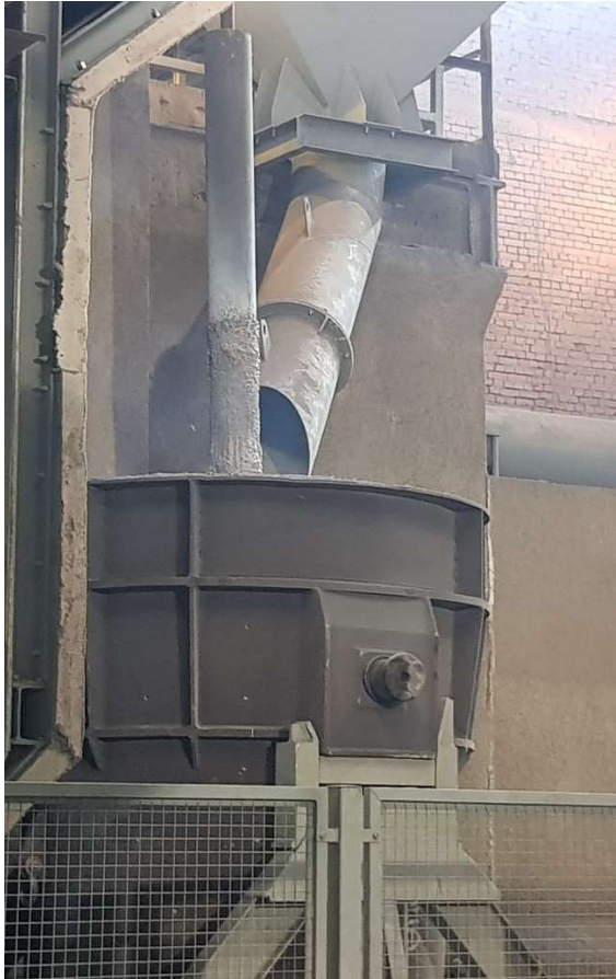
Rys. 77. Lanca do przedmuchiwania kąpieli metalowej FeSi75 mieszaniną gazów rafinacyjnych podczas postoju (po lewej) i podczas działania (po prawej).
