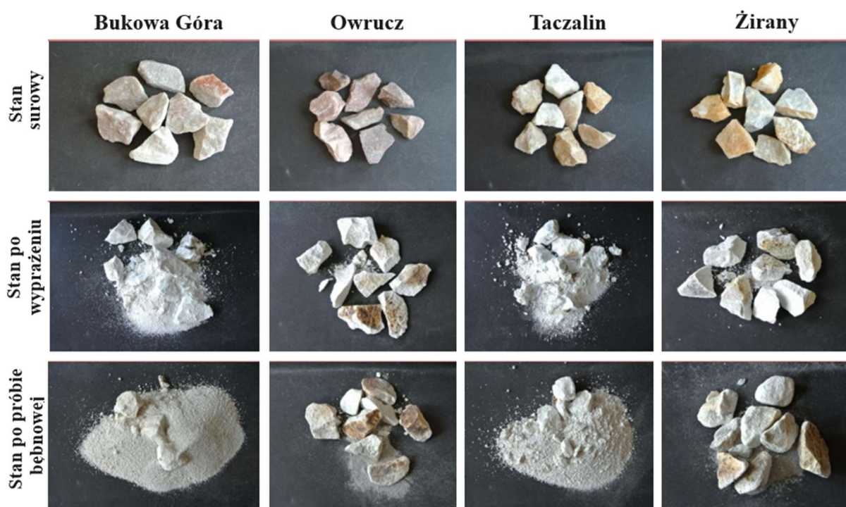
Rys. 37. Próbkki kwarcytów po badaniach stabilności termicznej w temperaturze 1600 °C [79]
