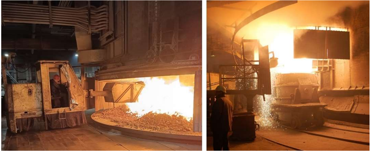
Rys. 72. Załadunek mieszanki wsadowej i spust metalu
