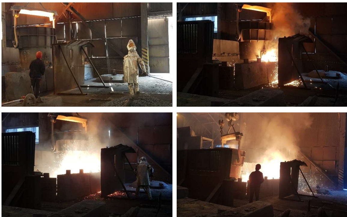
Rys. 74. Rozlewanie metalu po rafinacji do boksu żeliwnego
