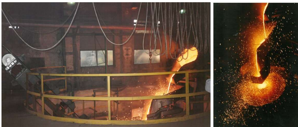
Rys. 94. Widok na instalację do wodnej granulacji żelazokrzemu przy piecu XVIB
