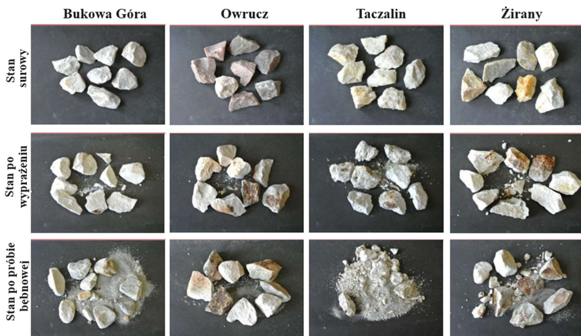
Rys. 36. Próbkki kwarcytów po badaniach stabilności termicznej w temperaturze 1450 °C [79]
