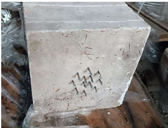
Rys. 78. Kształtka gazoprzepuszczalna wykorzystywana do przedmuchiwania kąpieli metalowej FeSi75 mieszaniną gazów rafinacyjnych przed montażem (po lewej) i zamontowana w dnie kadzi (po prawej).
