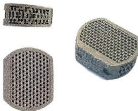
Ryc.18B. Zdjęcie próbki wytworzonej metodą SLM na podstawie projektu
