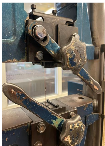
Rys. 64. Wykonywanie badań wytrzymałościowych złączy lutowanych na przykładzie lutu Zen-10 [opracowanie własne]
