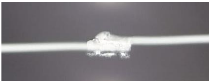
Rys. 70. Zdjęcie radiograficzne z niezgodnościami w postaci braków przetopu lutownicy (próbka Zen-8) [opracowanie własne]
