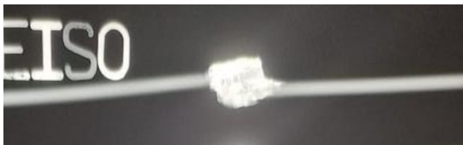
Rys. 72. Zdjęcie radiograficzne próbki Zen-2 z niezgodnościami w postaci występowania pęcherzyków powietrza oraz porowatości [opracowanie własne]
