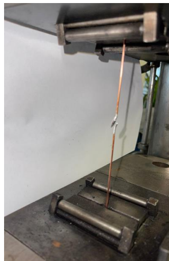
Rys. 63. Wykonywanie badań wytrzymałościowych złączy lutowanych na przykładzie lutu Zen-9 [opracowanie własne]
