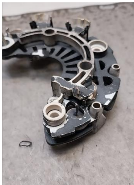
Rys. 13. Uszkodzone diody [opracowanie własne]
