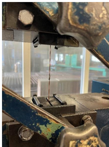
Rys. 61. Wykonywanie badań wytrzymałościowych złączy lutowanych na przykładzie lutu Zen-7 [opracowanie własne]
