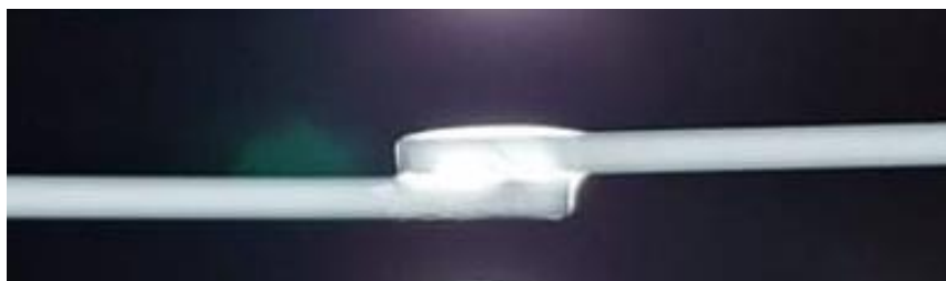
Rys. 74. Zdjęcie radiograficzne próbki Zen-10. Nie zaobserwowano wad w przetopie lutownicy [opracowanie własne]
