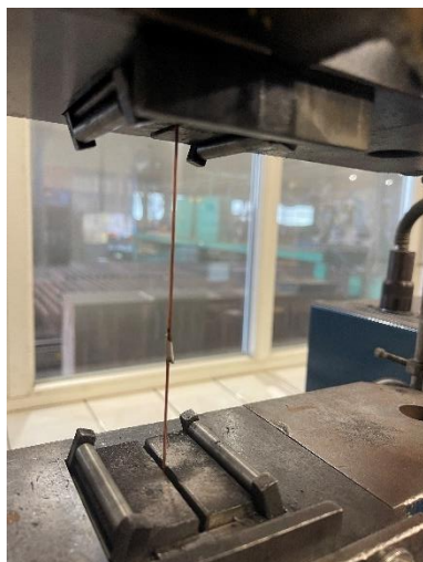
Rys. 63. Wykonywanie badań wytrzymałościowych złączy lutowanych na przykładzie lutu Zen-9 [opracowanie własne]
