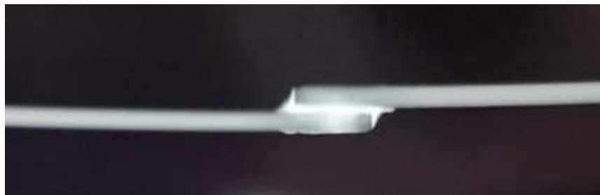
Rys. 73. Zdjęcie radiograficzne próbki Zen-5. Próbką nie posiada wad w przetopie lutownicy [opracowanie własne]
