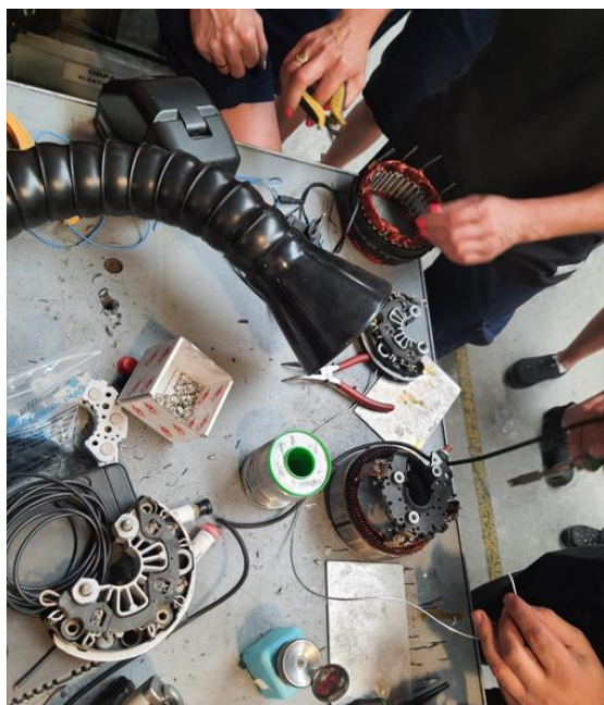
Rys. 91. Przygotowane połączenia elektryczne regenerowanego alternatora samochodowego [opracowanie własne]
