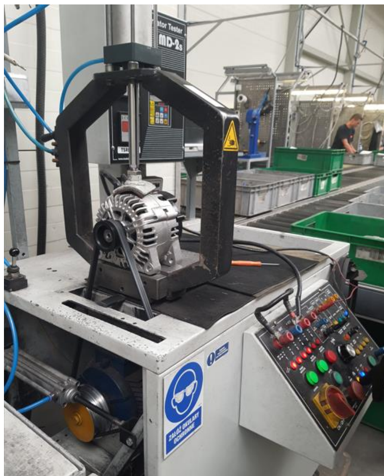
Rys. 93. Testy alternatora na maszynie testującej Starter&Alternator Tester MD-2s
