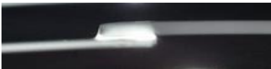
Rys. 75. Zdjęcie radiograficzne próbki Zen11. Brak widocznych wad przetopu lutowiny w wykonanym złączu [opracowanie własne]
