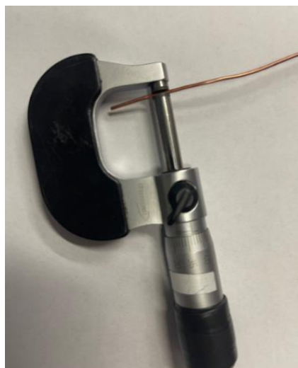
Rys. 58. Pomiar próbki mikrometrem [opracowanie własne]
