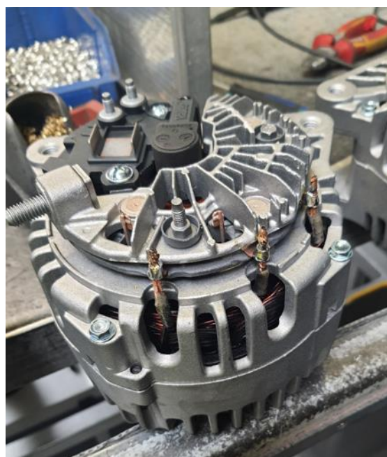
Rys. 91. Przygotowane połączenia elektryczne regenerowanego alternatora samochodowego [opracowanie własne]
