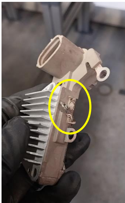
Rys. 16. Przerwane połączenia elektryczne [opracowanie własne]
