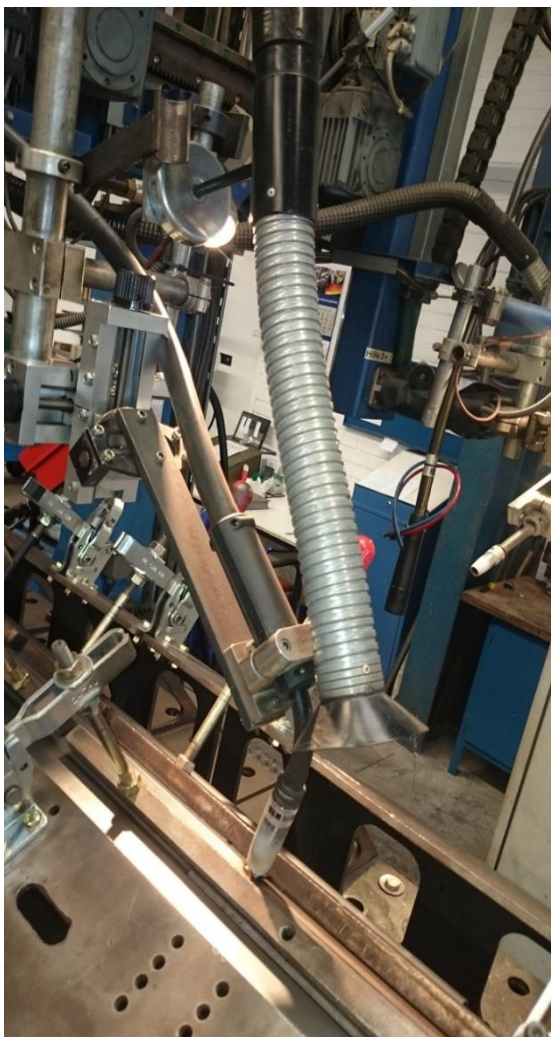
Rys. 27. Stanowisko do spawania elementów budowy podestów ruchomych przejezdnych montowanych na pojazdach samochodowych [źr. wł.]
