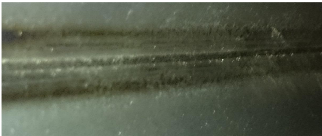
Rys. 31. Stan powierzchni spoin po spawaniu z helowym schładzaniem mikro-jetowym i zastosowaniem podkładki miedzianej [źr. wł.]
