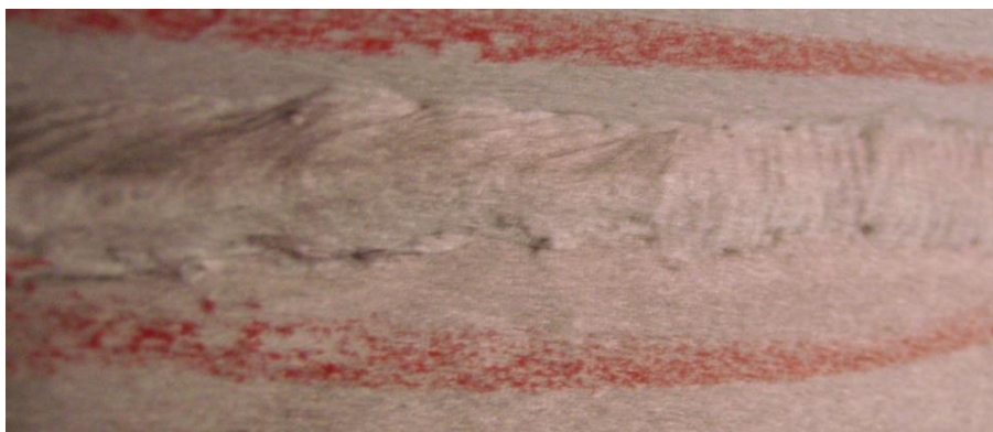
Rys. 20. Stan powierzchni spoin po spawaniu MAG w osłonie CO 2 [źr. wł.]
