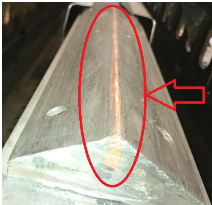
Rys. 26. Podkładka miedziana formująca lico spoiny podestu ruchomego [źr. wł.]
