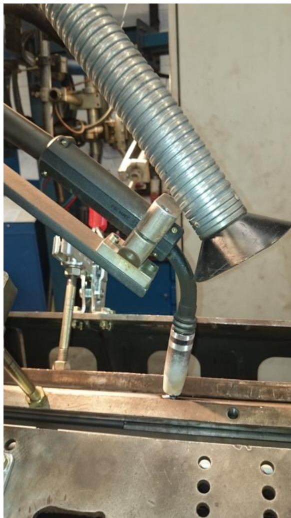
Rys. 27. Stanowisko do spawania elementów budowy podestów ruchomych przejezdnych montowanych na pojazdach samochodowych [źr. wł.]
