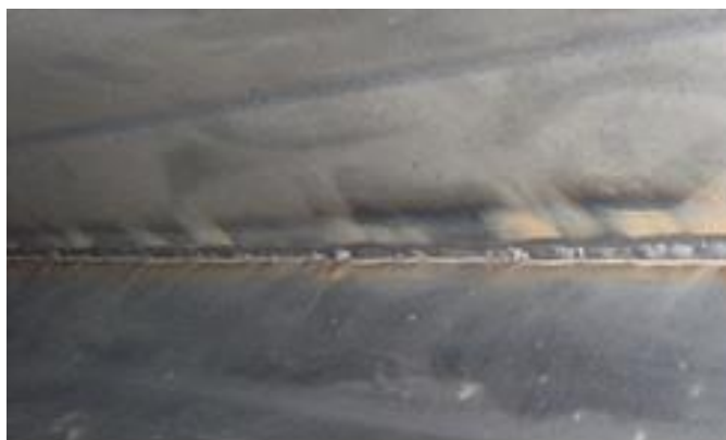
Rys. 22. Stan powierzchni spoiny po spawaniu MAG z chłodzeniem mikro-jet [źr. wł.]
