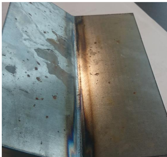
Rys. 28. Stan powierzchni złącza elementów podestu ruchomego od strony grani po spawaniu MAG w osłonie 82\% \text{ Ar} + 18\% \text{ CO}_2 , zastosowana miedziana podkładka formująca [źr. wł.]
