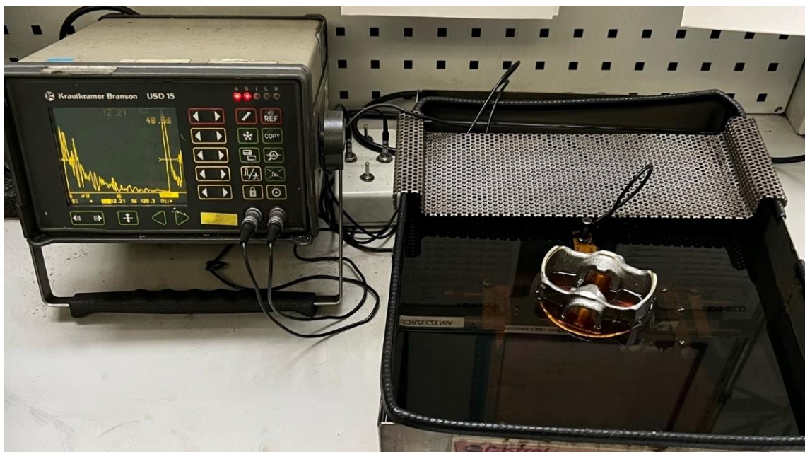
Rys.2.15. Ręczy ultrasonograf do kontroli jakości tłoków jeszcze podczas produkcji (materiały będące własnością F-M Gorzyce).
