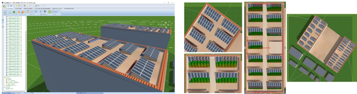
Rysunek 47. Budynek CRON Układ Paneli 2x(13x2x7) Moc 120,12 kWp
