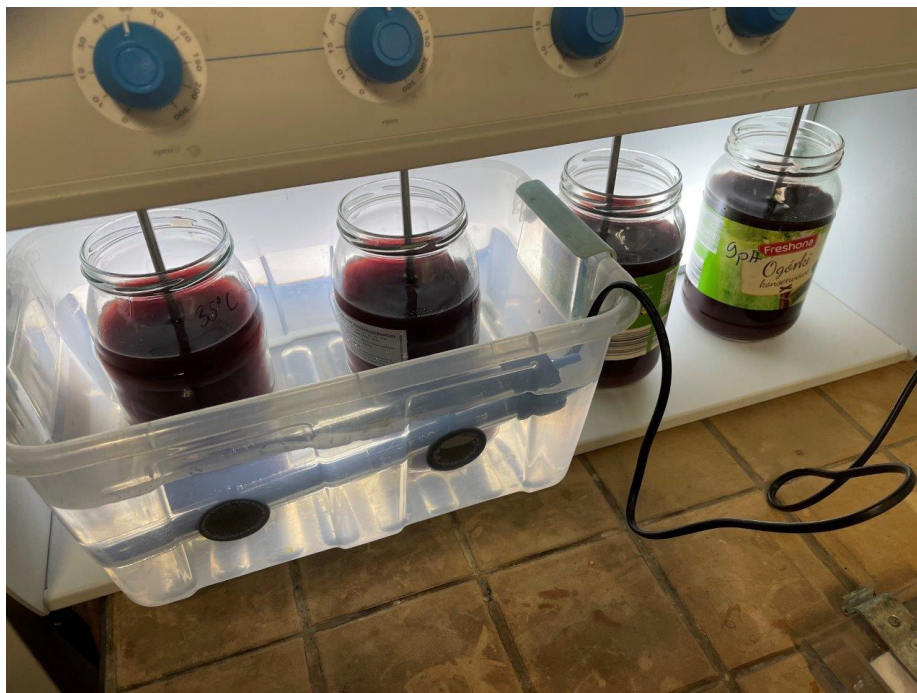
Rysunek 26. Flokulator z próbkami ścieków poddanymi hydrolizie.
