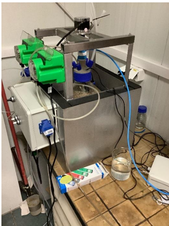
Rysunek 5. Reaktor pilotowy umieszczony w kąpiel wodnej z dwiema pompami perystaltycznymi firmy Milwaukee MP815.
