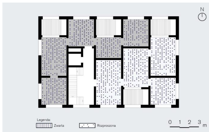
Ryc. 2.30. Rzut kondygnacji powtarzalnej, ukształtowanie rzutu wyrażające rozproszoną organizację użytkowania, źródło: www.dienerdiener.ch , dostęp: 9.09.2022 r.
