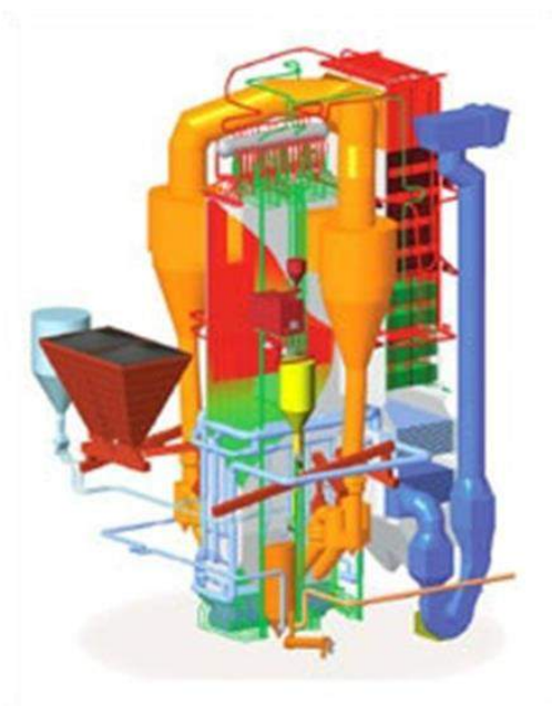
Rysunek 3.5. Kocioł fluidalny OFz-230 z cyrkulacyjną warstwą fluidalną z paleniskiem atmosferycznym, oraz naturalną cyrkulacją po stronie wody i pary, o wydajności pary 230,4 t/h, opalany węglem kamiennym. Producentem kotła jest Rafako SA
