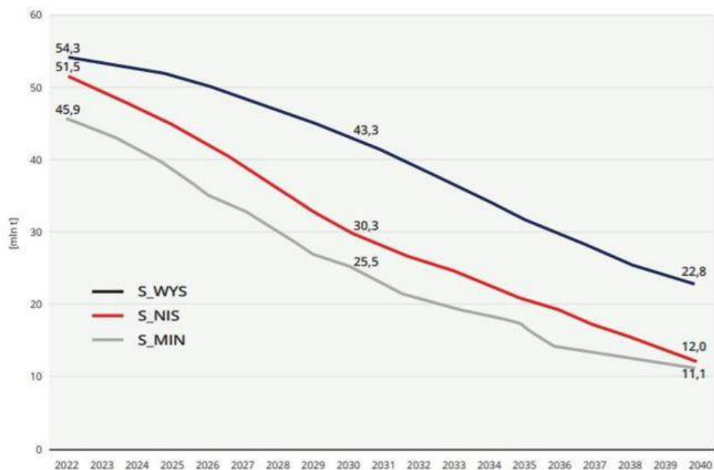
Rysunek 1.9. Prognoza zapotrzebowania na węgiel do celów energetycznych w scenariuszach wysokim, niskim i minimalnym (wg analizy scenariuszowej bilansu podaży-popytu węgla kamiennego w Polsce do 2040 r.) [6]
