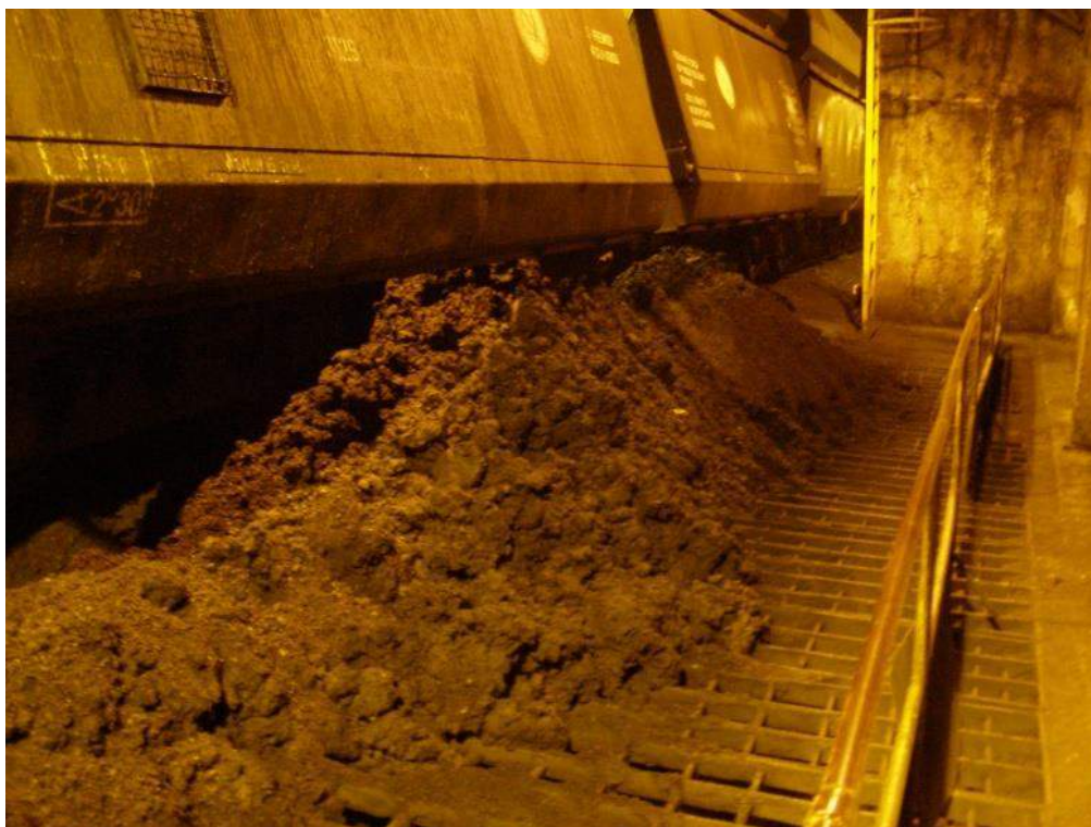
Rysunek 16.2. Rozładunek paliwa – przykład blokowania się węgla na kratkach rozładowniczych zasobnika szczelinowego
