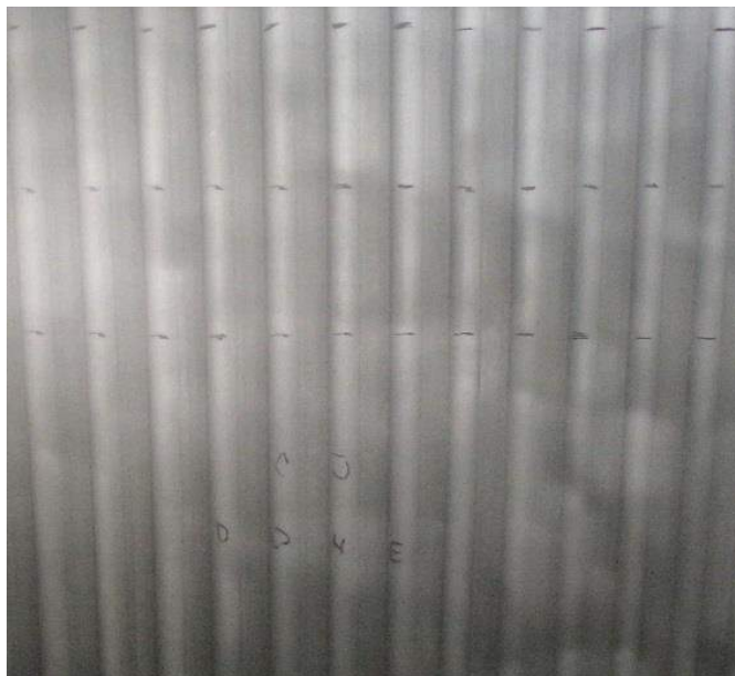
Rysunek 16.14. Powłoka nałożona metodą metalizacji natryskowej IGS 8450
