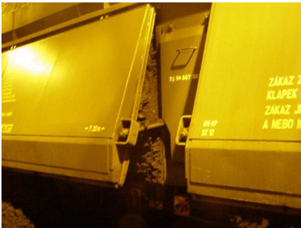
Rysunek 16.1. Rozładunek paliwa – przykład oklejanie się wagonów węglem o niskiej podatności transportowej
