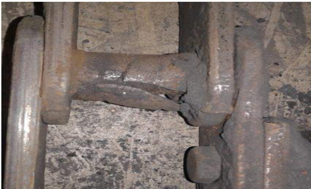
Rysunek 16.4. Układ podawania węgla – przykład uszkodzonego łańcucha podajnika węgla
