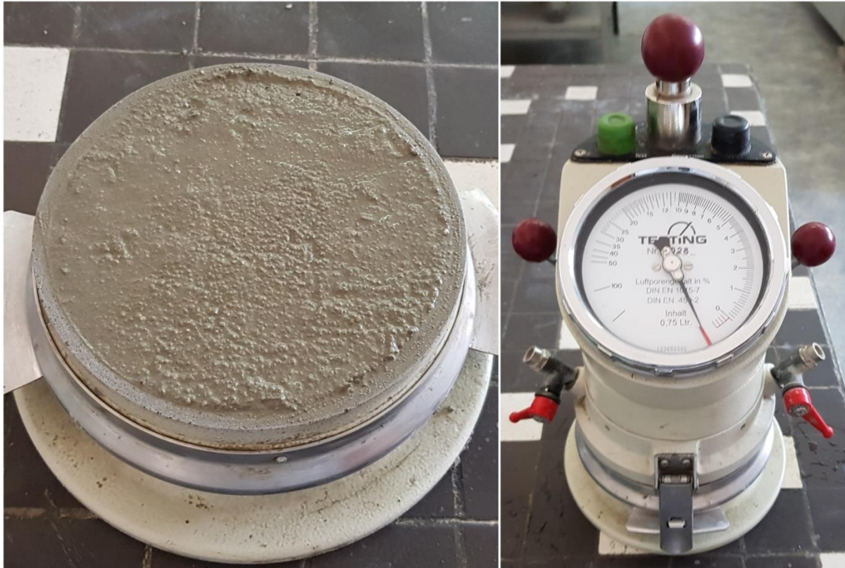
Rys. 29. Badanie zawartości powietrze zaprawy przed związaniem
