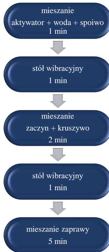
Rys. 43. Schemat mieszania zaprawy na bazie metakaolinu
