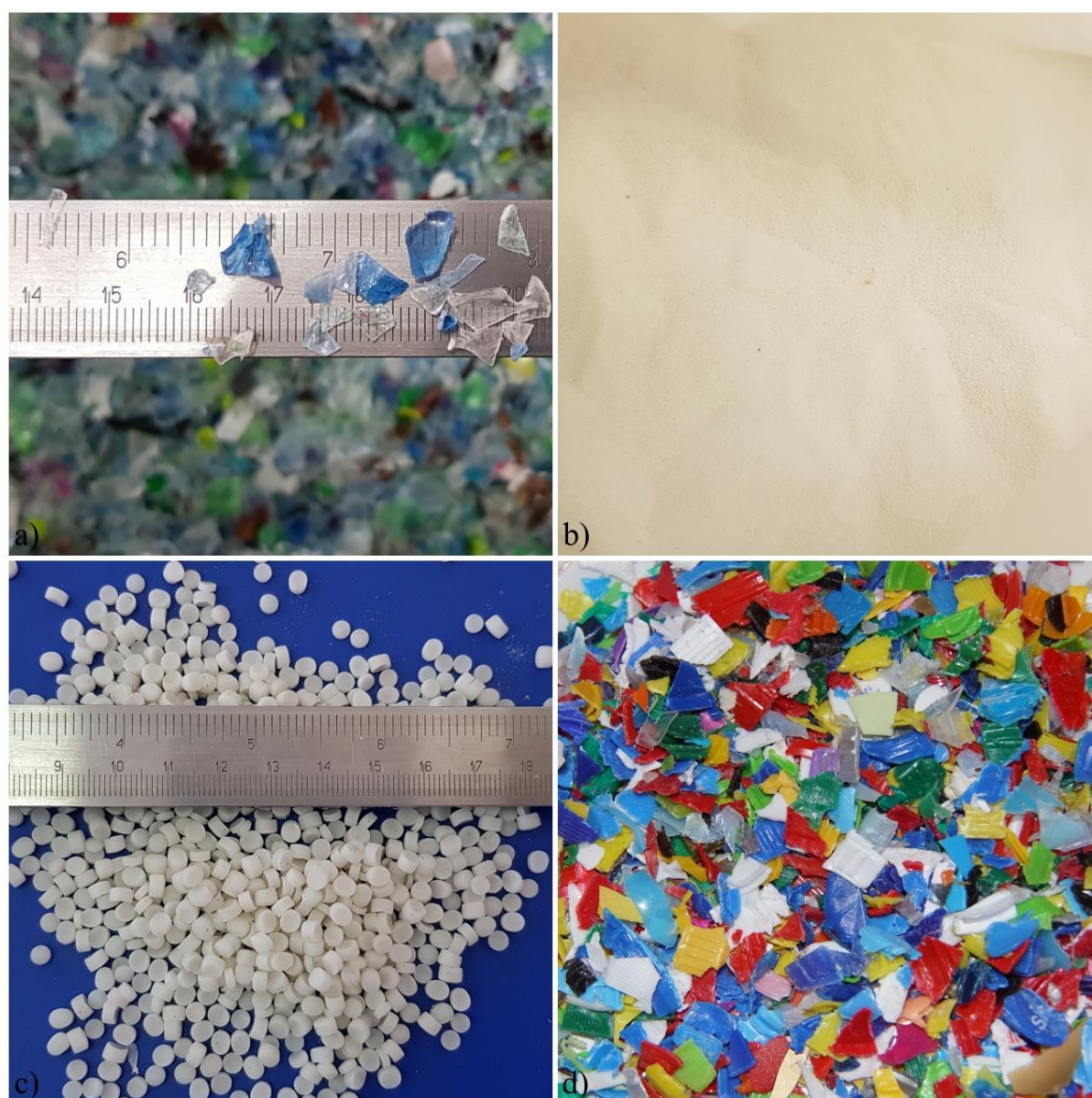
Rys. 26. Odpady z tworzyw sztucznych wykorzystanych w badaniu: a) płatki PET, b) sproszkowany PVC, c) granulat PET, d) HDPE
