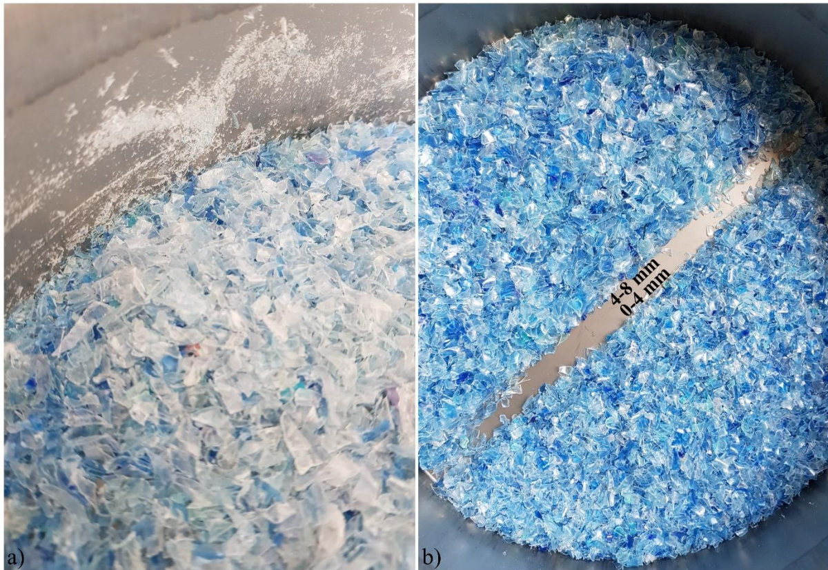
Rys. 32. Frakcje PET: a) 0-4 mm, b) 50% 0-4 mm + 50% 4-8 mm
