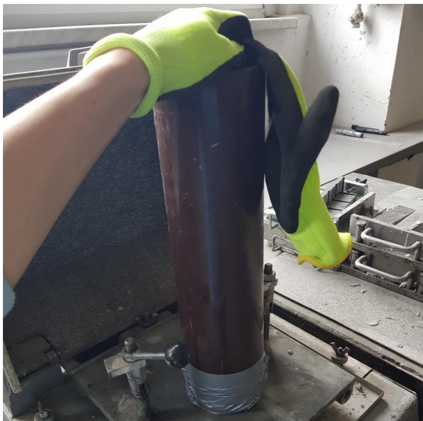
Rys. 37. Zagęszczanie zaprawy przeznaczonej do badania przepuszczalności chlorków
