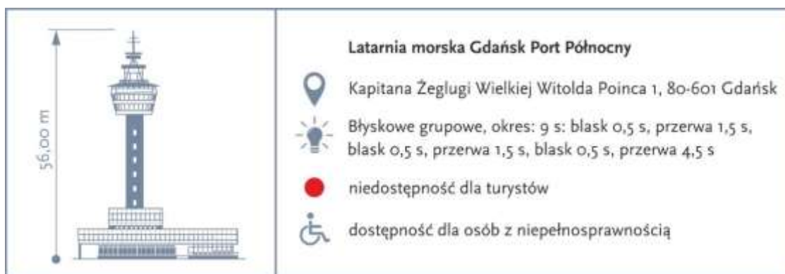
Ilustracja 41: Podstawowe dane latarnia morska Gdańsk Port Północny
