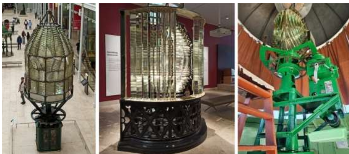
Ilustracja 2: Urządzenia optyczne z soczewką Fresnela: il. 1 i il. 2 dawne soczewki prezentowane w National Museum of Scotland, il. 3. działające urządzenie optyczne latarnia morska Castillo del Morro, Hawana, Kuba
