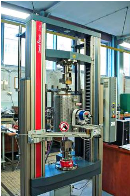
Figure 59. The ZWICK Z250 tensile machine [82]
