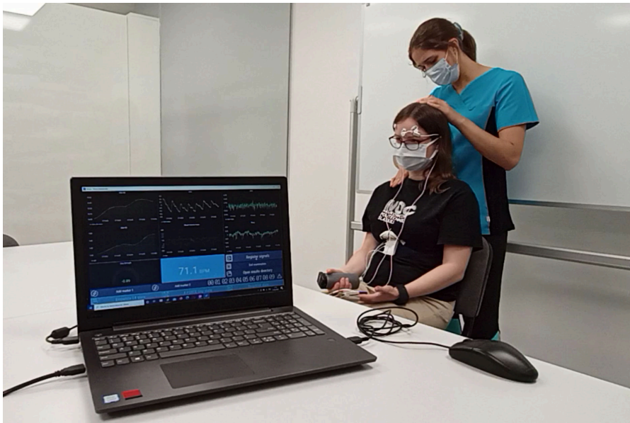
Rys. 3.1: Platforma pomiarowa, w skład której wchodzi stacja komputerowa z interfejsem graficznym oraz bezprzewodowe urządzenia pomiarowe: biosignalsplux i KFORCE Grip.
