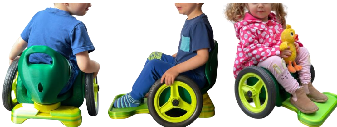
Rys. 81. Fizyczne testowanie prototypu z przeprojektowanym podnóżkiem
