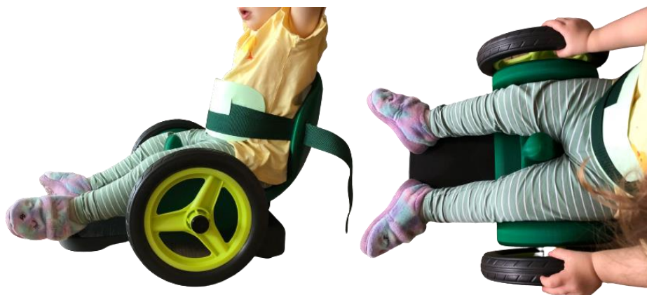
Rys. 78. Weryfikacja fizyczna pojazdu z użytkownikiem w wieku: 2 lata, wzrost: 90 cm, masa: 15 kg
