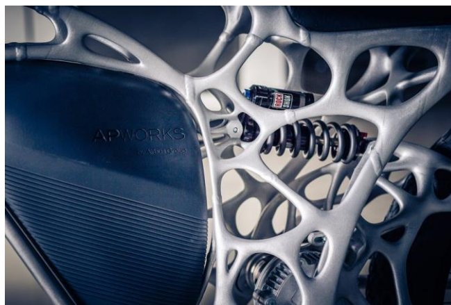
Rys. 37. Widoczne miejsca spawania wydrukowanych części ramy aluminiowej [82]
