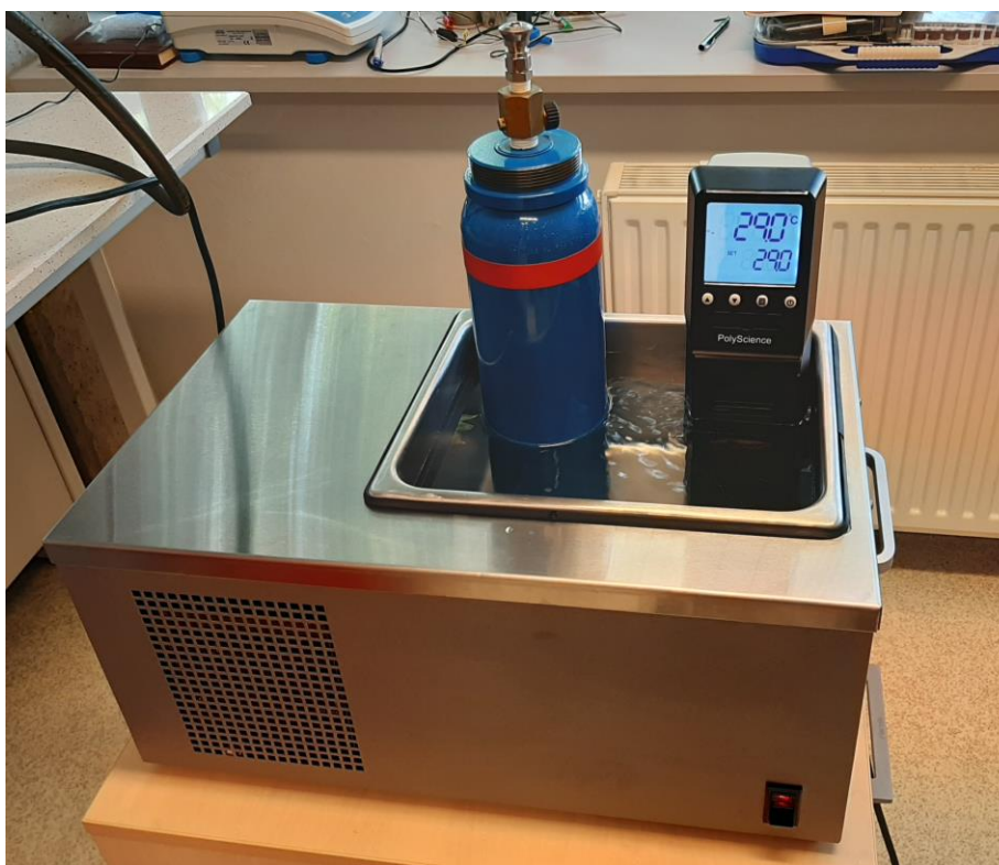
Rys. 5.5. System chłodzenia zastosowany w instalacji
