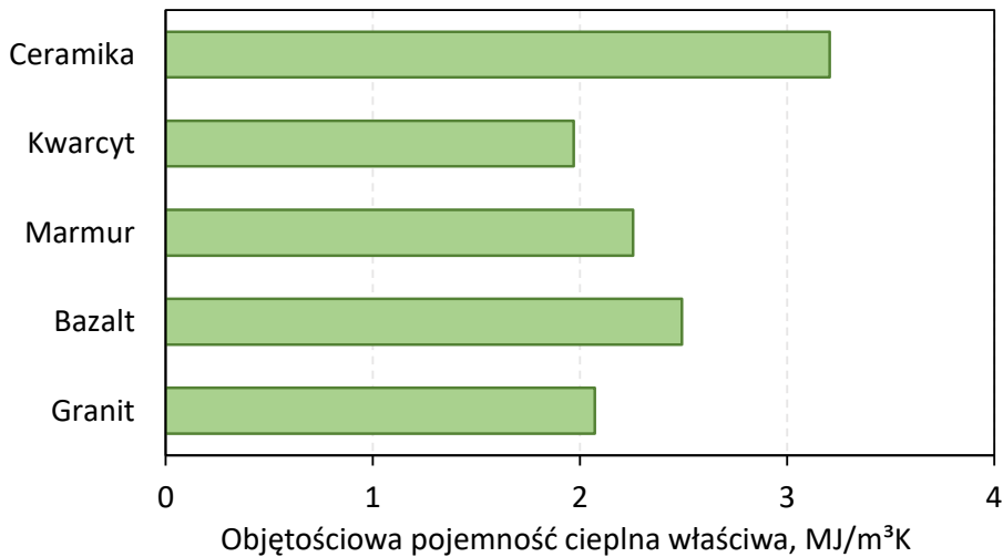
Rysunek 2.3 Średnia objętościowa pojemność cieplna właściwa wybranych materiałów akumulacyjnych
