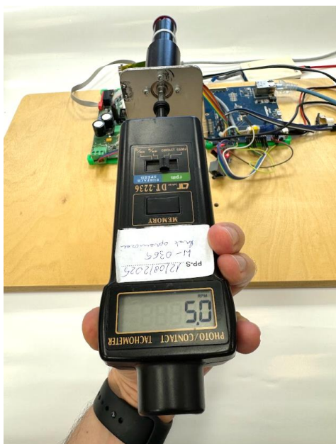
Rys. 5.3 Sposób sprawdzenia dokładności pomiaru prędkości obrotowej
