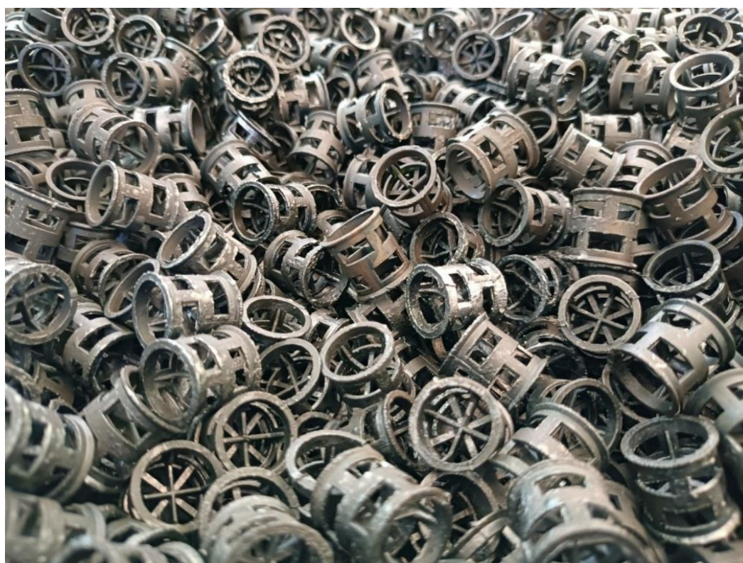
Rys. 77. Górna warstwa złoża KBT, po rocznych testach w oczyszczalni ścieków „Klimzowiec”. (Próbki pobrano z czterech miejsc bioreaktora na 3 poziomach wysokości złoża)
