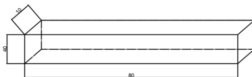
Rysunek 27. Wymiary próbek używanych do badania temperatury ugięcia HDT
