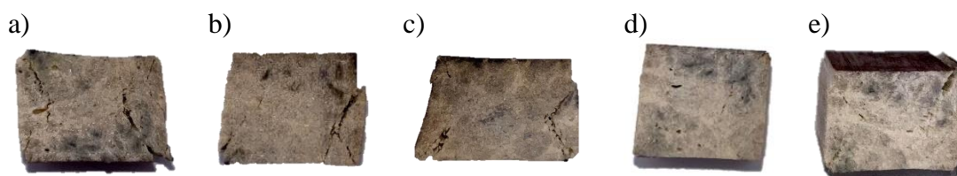
Rysunek 35. Ściskane próbki poliuretanowe przed komorą klimatyczną. a) próbka nr 1, b) próbka nr 2, c) próbka nr 3, d) próbka nr 4, e) próbka nr 5
