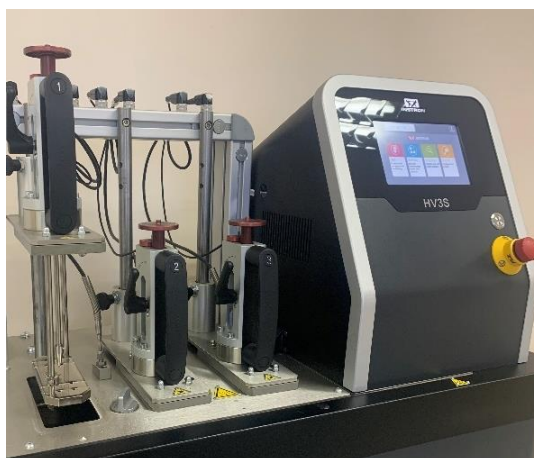
Rysunek 28. Maszyna do badań temp. ugięcia pod obciążeniem HDT Instron HV3S
