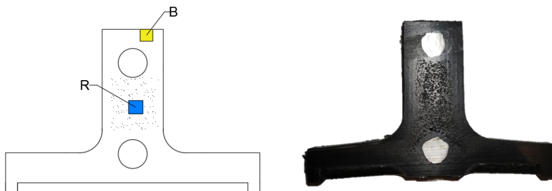
Rysunek 24. Oznaczenia próbek z przekroju poprzecznego podkładu polietylenowego
