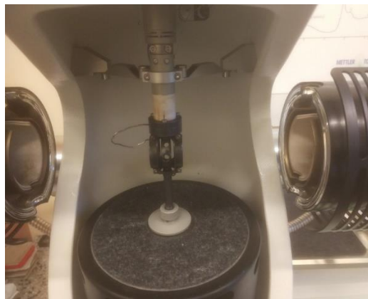
Rysunek 56. Sprzęt DMA 861e firmy Mettler-Toled, a) po lewe całe urządzenie, b) po prawej przybliżenie na miejsce usytuowania próbki
