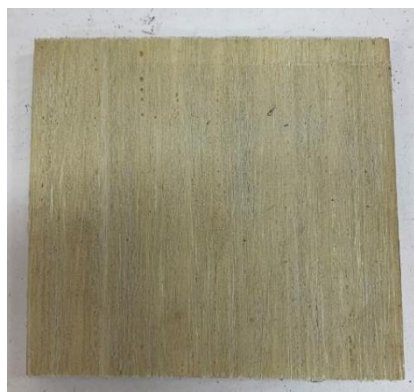
Rysunek 60. Próbką podkładu poliuretanowego przygotowana do badania palności
