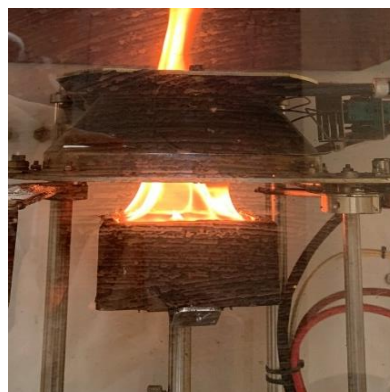
Rysunek 61. Próbką podkładu poliuretanowego podczas badania palności
