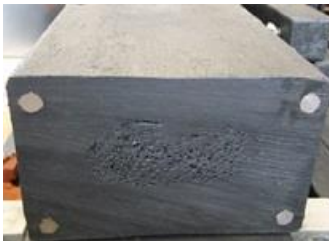
Rysunek 15. Przekrój podkładu polietylenowego- blokowego [9]
