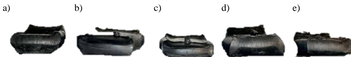
Rysunek 31. Ściskane próbki polietylenowe brzegowe (PE B) przed komorą. a) próbka nr 1, b) próbka nr 2, c) próbka nr 3, d) próbka nr 4, e) próbka nr 5
