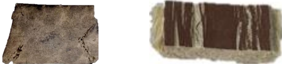
Rysunek 39. Porównanie próbek PU, a) przed komorą, b) po komorze
