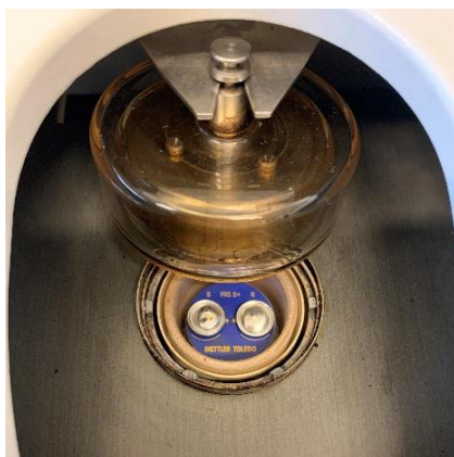
Rysunek 55. Umiejscowione dwa pojemniki badawcze- jeden z próbką badawczą a drugi wzorcowy- pusty
