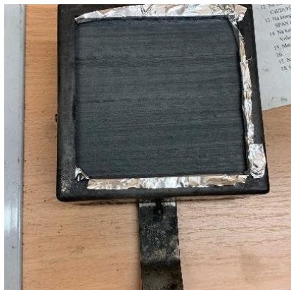
Rysunek 58. Próbką podkładu polietylenowego przygotowana do badania palności
