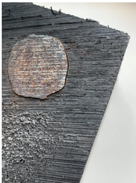
Rysunek 77. Blok podkładu polietylenowego po ekspozycji w komorze klimatycznej
