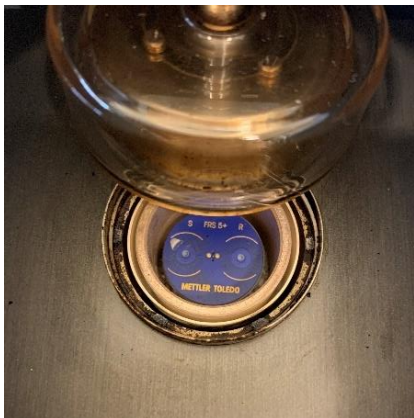
Rysunek 51. Miejsce na próbki badawcze w różnicowym kalorymetrze skaningowym
