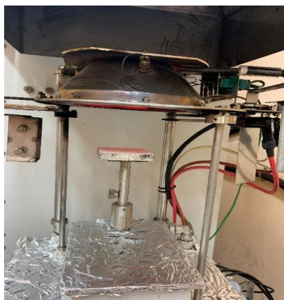
Rysunek 57. Kalorymetr stożkowy firmy Fire Testing Technology., a) urządzenie bez próbki, b) urządzenie z próbką
