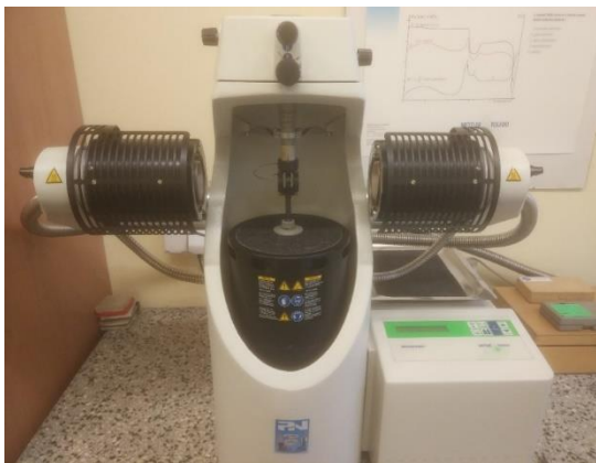
Rysunek 56. Sprzęt DMA 861e firmy Mettler-Toled, a) po lewe całe urządzenie, b) po prawej przybliżenie na miejsce usytuowania próbki
