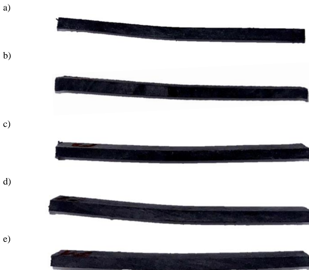
Rysunek 41. Zginane próbki PE przed komorą. a) próbka nr 1, b) próbka nr 2, c) próbka nr 3, d) próbka nr 4, e) próbka nr 5
