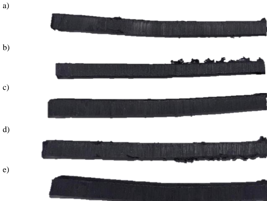
Rysunek 42. Zginane próbki PE po komorze. a) próbka nr 1, b) próbka nr 2, c) próbka nr 3, d) próbka nr 4, e) próbka nr 5
