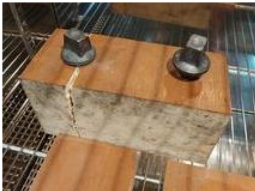
Rysunek 78. Blok podkładu poliuretanowego po ekspozycji w komorze klimatycznej
