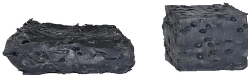
Rysunek 37. Porównanie próbek PE (rdzeń), a) przed komorą, b) po komorze
