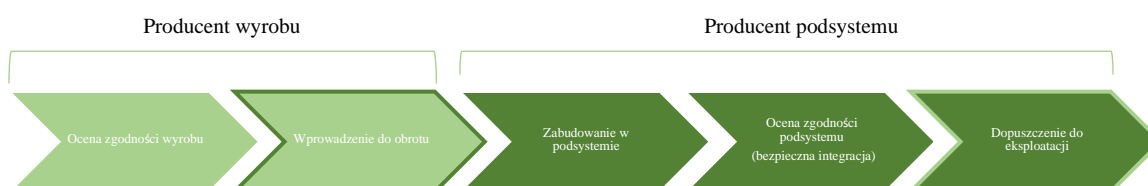
Rysunek 19. Schemat dopuszczenia podkładu innowacyjnego do eksploatacji
