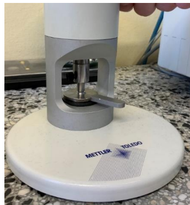
Rysunek 54. Proces szczelnego zamknięcia spreparowanej próbki badawczej w pojemniku badawczym
