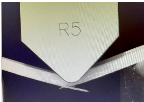
Rysunek 47. Próbką PU przed komorą podczas badania zginania
