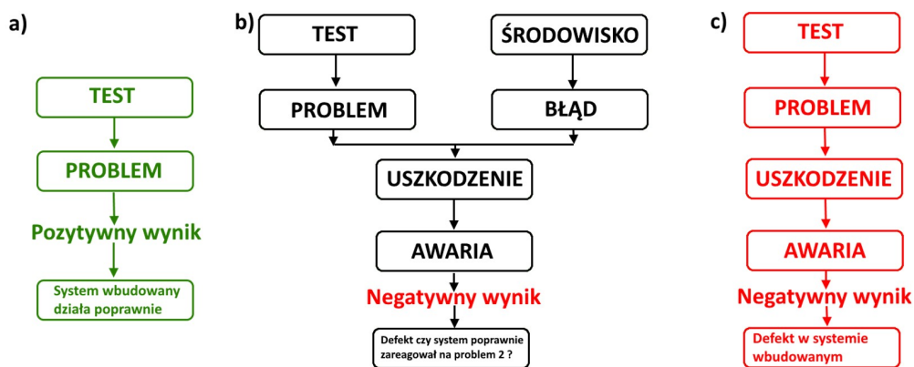
Rys. 2.11. Zależności między pojęciami opisującymi nieprawidłowości w działaniu oprogramowania [83]
