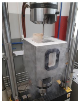
Rysunek 10. Stanowisko do trójpunktowego testu zginania wyposażone w kriostat kriogeniczny, a) geometria próbki, b) komora kriogeniczna.
