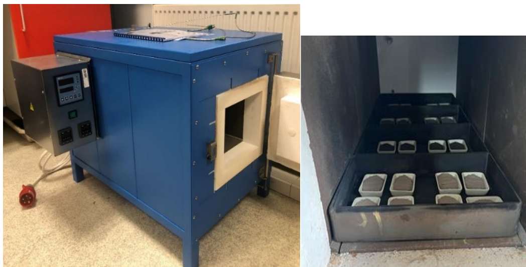
Rys. 7-9. Próbkki stali pokryte popiołem umieszone w piecu muflowym.
