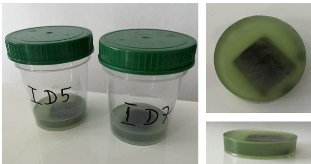
Rys. 7-10. Kupony pomiarowe zainkludowane w żywicy.
