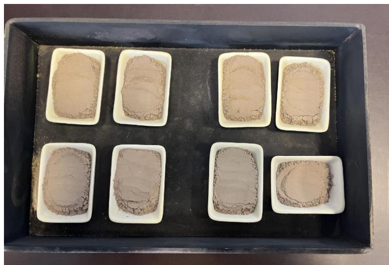
Rys. 7-8. Próbkki stali pokryte popiołem przed umieszczeniem w piecu muflowym.
