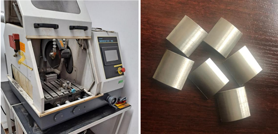
Rys. 7-5. Przygotowanie próbek do badań – piła tarczowa i pierścienie pocięte na kupony.
