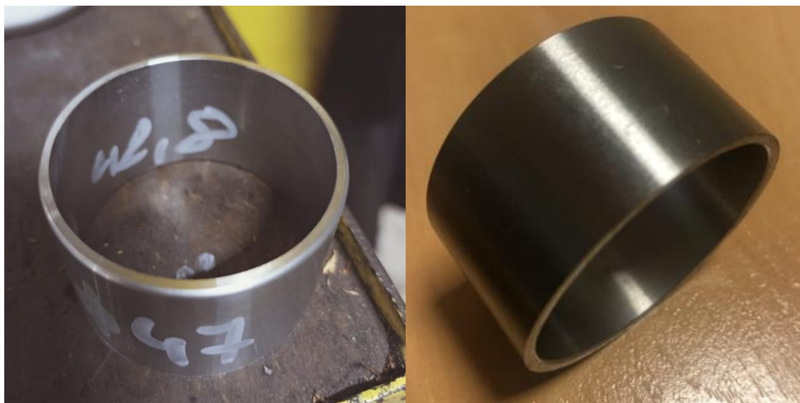
Rys. 7-4. Przygotowanie próbek do badań – rury pocięte na pierścienie.
