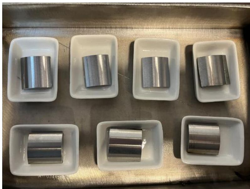
Rys. 7-7. Próbki stali przygotowane do przeprowadzenia badań korozyjnych.
