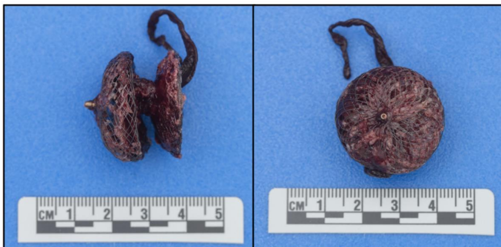
Rys. 21. Eksplantowany okluder do zamykania ubytku w przegrodzie międzyprzedsionkowej (ASD), w którym widoczne jest nieprawidłowe tworzenie się tkanki i skrzepliny [91]
