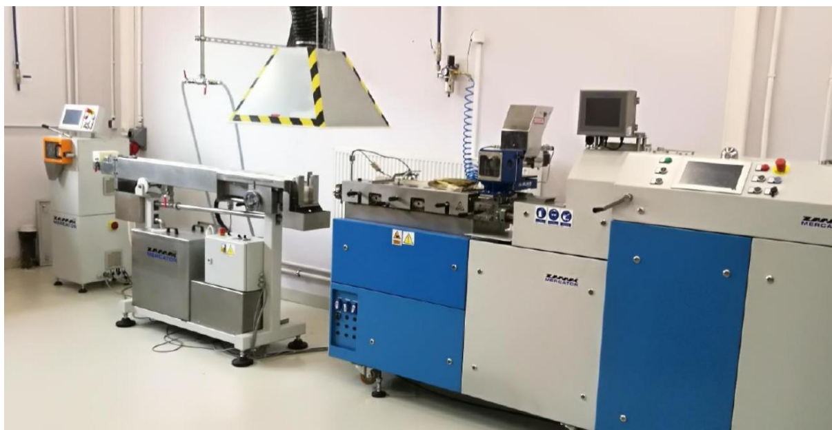
Rysunek 34. A) Wanna chłodząca, B) Wytłaczanie mieszanki „dry-blend”, C) linia do granulacji firmy ZAMAK MERCATOR z wytłaczarką dwuślimakową RES-2P/24A i granulatorem. Zdjęcia wykonane w Grupie Azoty Zakłady Azotowe Kędzierzyn S.A.
