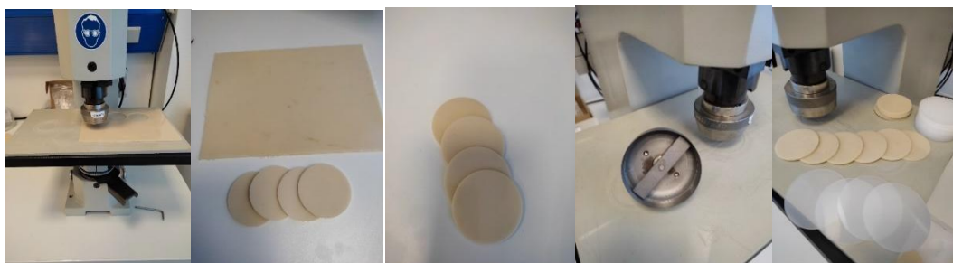
Rysunek 28. Wykrawanie kształtek przeznaczonych do badania migracji plastyfikatora z tworzywa sztucznego. Zdjęcie wykonane w Grupie Azoty Zakłady Azotowe Kędzierzyn S.A.
