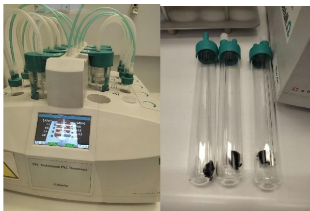
Rysunek 30. Urządzenie do przeprowadzenia stabilności termicznej PVC firmy Metrohm oraz naczynia reakcyjne. Zdjęcie wykonane w Grupa Azoty Zakłady Azotowe Kędzierzyn S.A.
