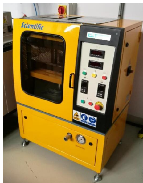
Rysunek 36. Prasa hydrauliczna Scientific firmy LabTech Engineering Company LTD Zdjęcie wykonane w Grupie Azoty Zakłady Azotowe Kędzierzyn S.A.
