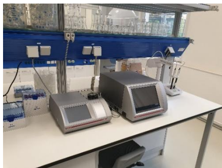
Rysunek 27. Gęstościomierz DMA 4100M oraz refraktometr cyfrowy Abbemat 350, firmy Anton Paar. Zdjęcie wykonane w Grupa Azoty Zakłady Azotowe Kędzierzyn S.A.
