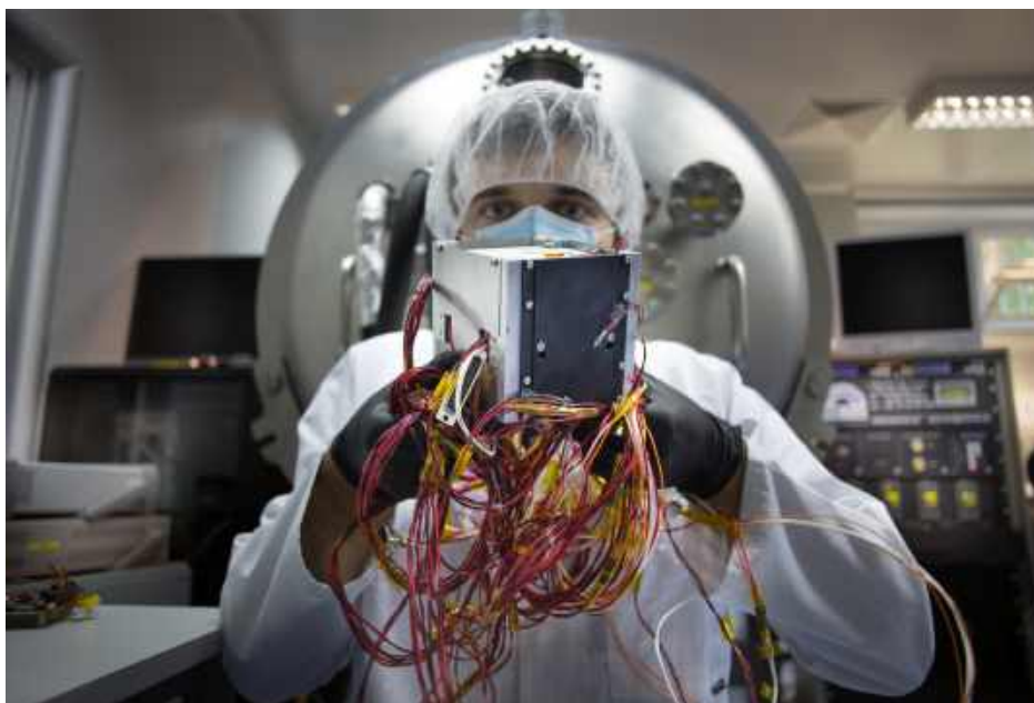
Rysunek 3.8: Prototyp jednostki obliczeniowej z wiązką przewodów czujników temperatury i zasilania. Zdjęcie wykonane po testach urządzenia w komorze TVAC w Centrum Badań Kosmicznych. Na zdjęciu autor pracy doktorskiej
