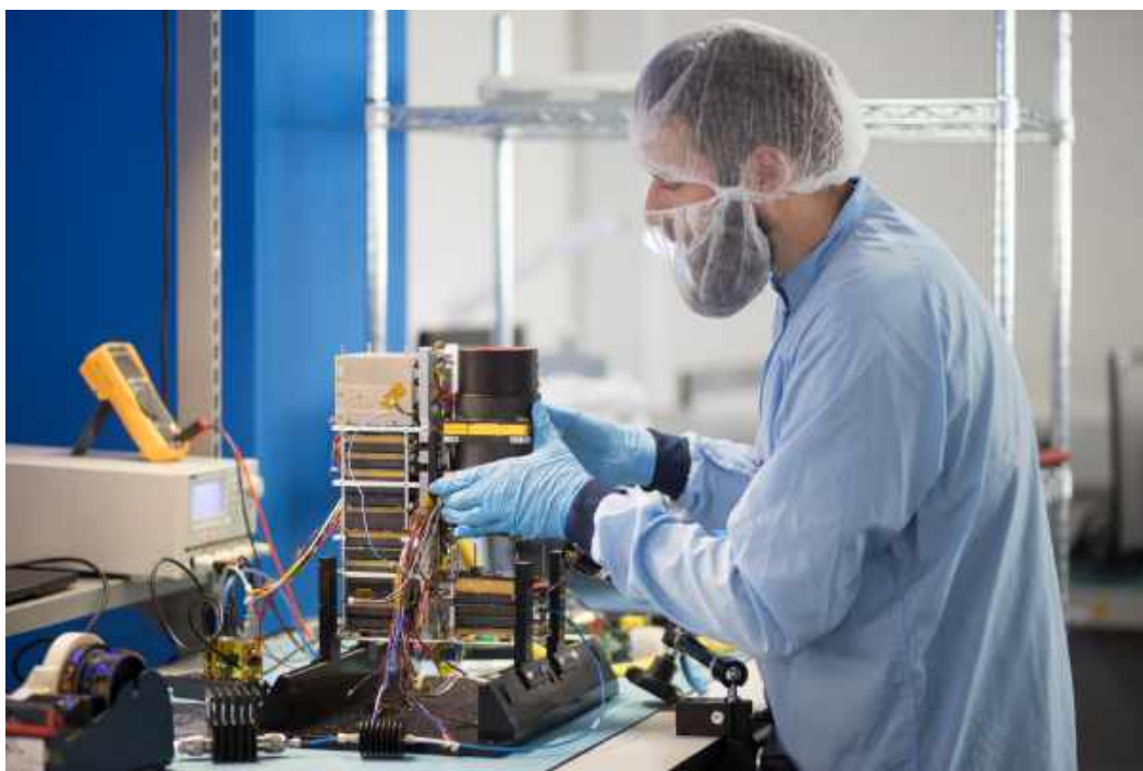
Rysunek 2.6: Moment montażu ładunku użytecznego (obiektywu hiperspektralnego) do satelity Intuition-1 wykonywany przez pracownika firmy KP Labs Sp. z o.o. (autora tej pracy doktorskiej)
