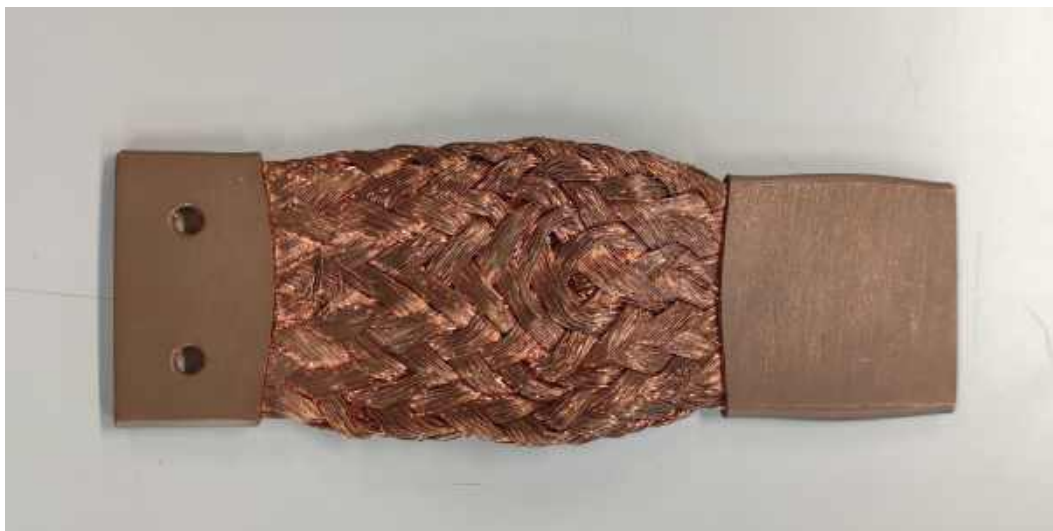
Rysunek 2.18: Przykładowe zdjęcie elastycznej taśmy termicznej wykorzystującej jako element łączny splot miedziany. Wykonanie na bazie projektu KP Labs Sp. z o.o.
