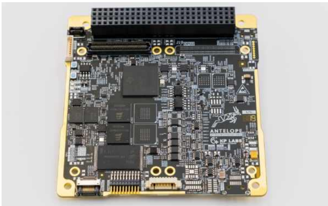
Rysunek 2.9: Komputer pokładowy (OBC) wyprodukowany przez firmę KP Labs sp. z o.o. przetestowany w środowisku kosmicznym na pokładzie satelity ION w 2023 roku
