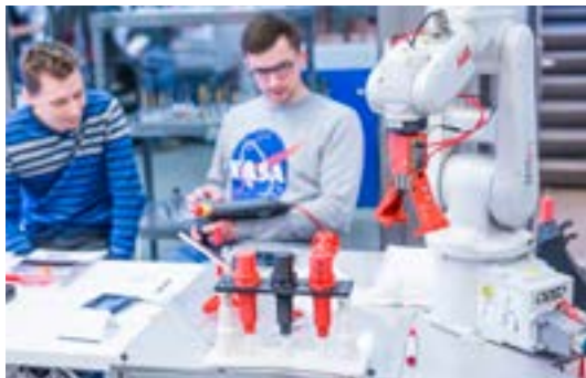
Przykład narzędzi zamontowanych na robocie ABB przygotowanych metodą druku 3D, wielokrotnie uszkodzonych podczas przebiegu kursu.
