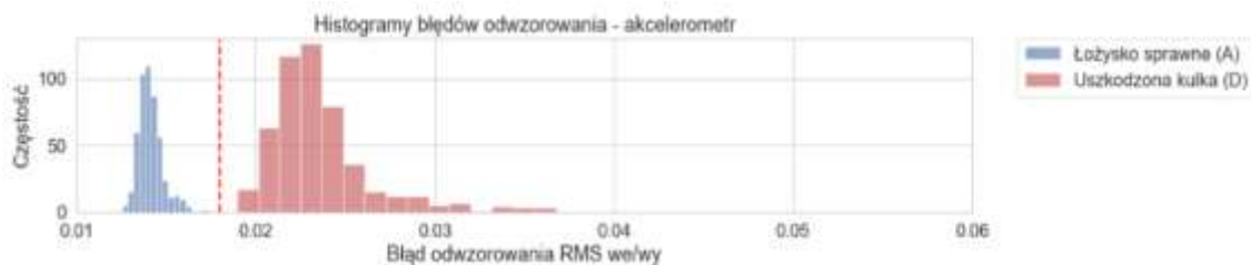
Rysunek 26. Monitorowanie pracy urządzenia z wykorzystaniem autoenkodera w diagnostyce prewencyjnej [9]
