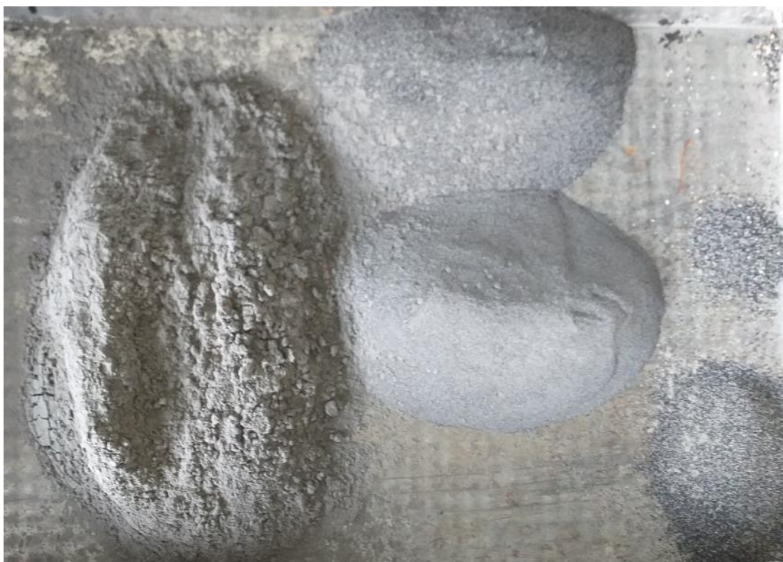
Rys. 4.7. Próbkę popiołu lotnego krzemionkowego (V) po badaniu uziarnienia [fot. własna]
