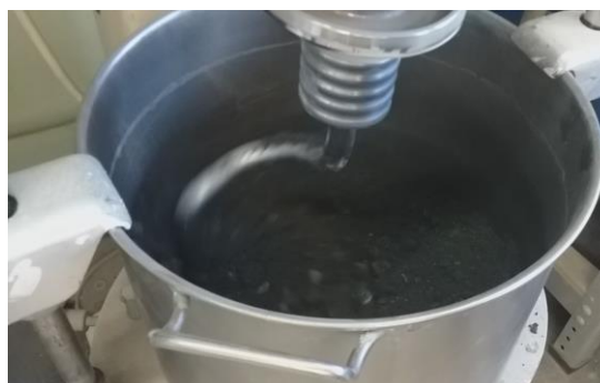
Rys. 3.9. a) Łupek przywęglowy nieprzepsalony z dodatkiem mieszanki spoiwowej; b) jednorodna mieszanka ŁGPC [fot. własne]
