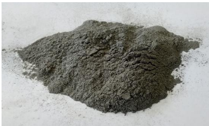
Rys. 3.3. Popiół lotny krzemionkowy zastosowany w badaniach [fot. własna]
