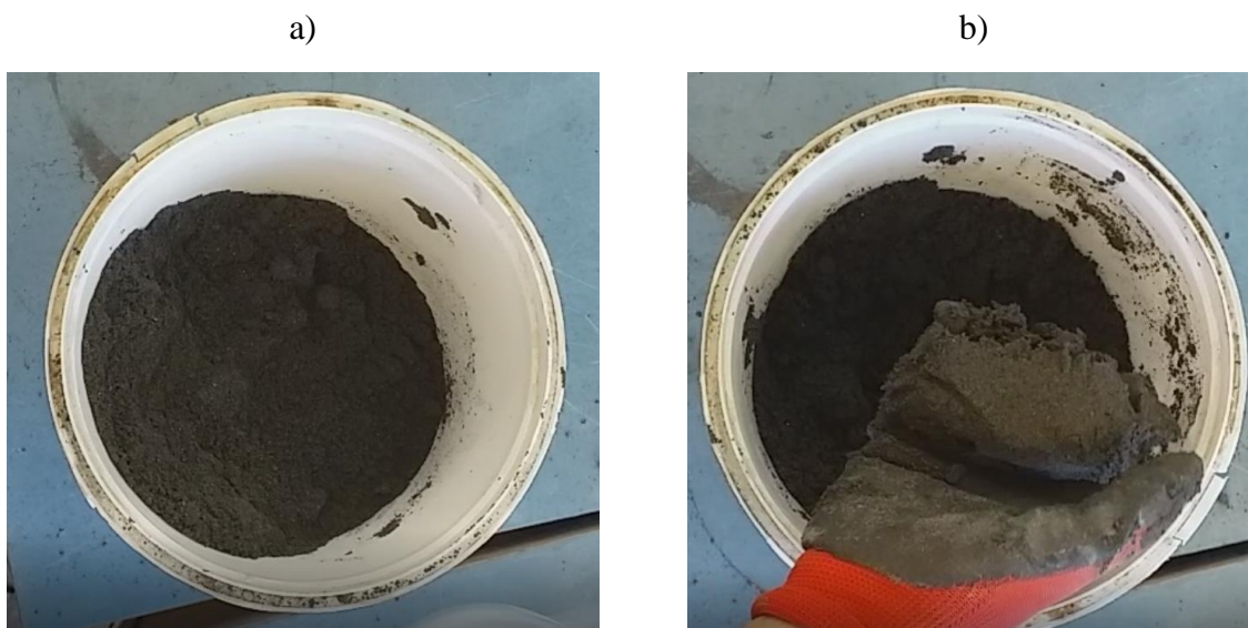
Rys. 3.7. a) Jednorodna mieszanka spoiwowa po pierwszym dodaniu wody; b) jednorodna mieszanka spoiwowa po ostatnim dodaniu wody [fot. własne]
