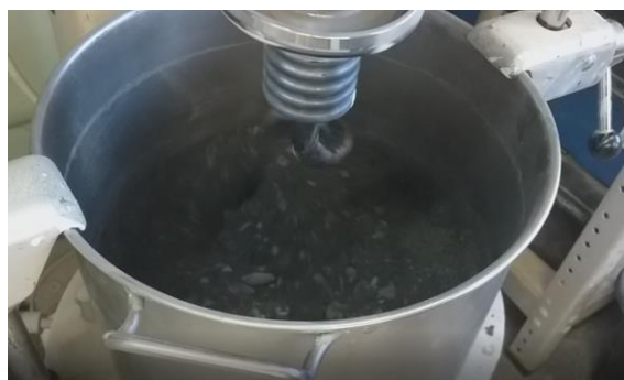
Rys. 3.9. a) Łupek przywęglowy nieprzepsalony z dodatkiem mieszanki spoiwowej; b) jednorodna mieszanka ŁGPC [fot. własne]
