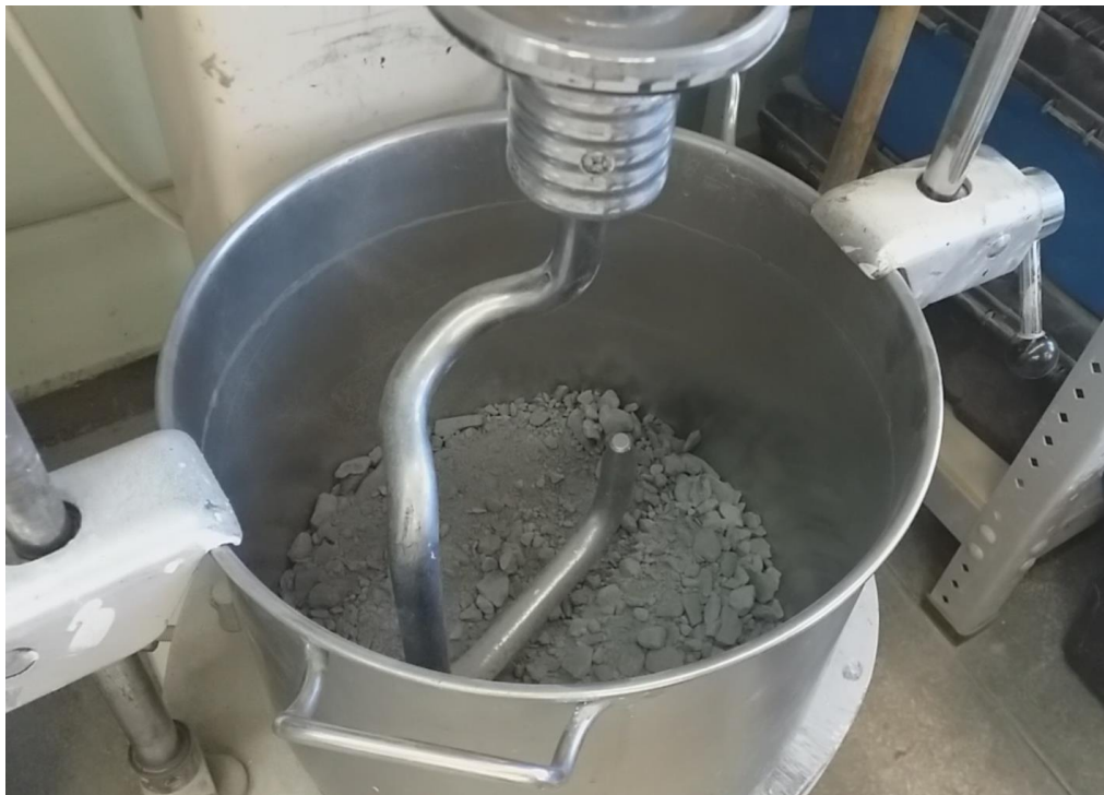
Rys. 3.8. Łupek przywęglowy nieprzepsalony w misie mieszadła hakowego [fot. własna]
