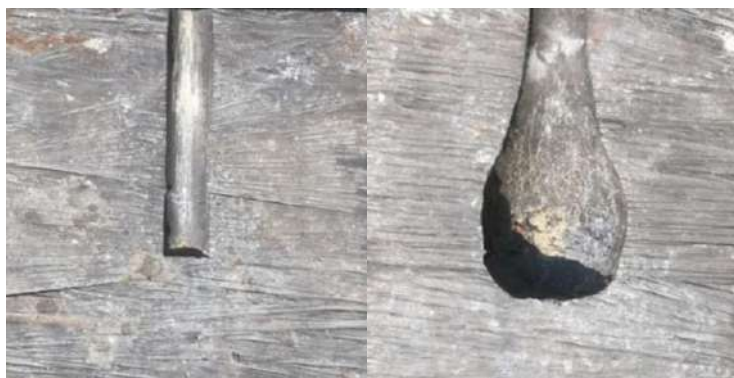
Rysunek 9. Przekrój bloku ołowianego przed detonacją (z lewej) i po detonacji (z prawej) [E2].
