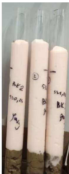
Rysunek 13. Przygotowane ładunki badanych MWE w rurach szklanych.
