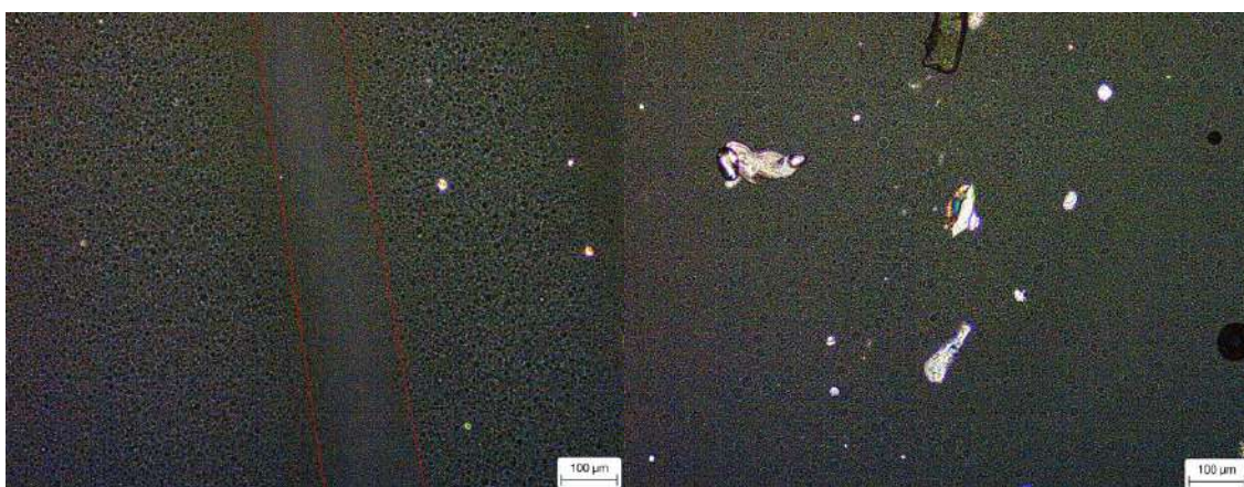
Rysunek 16. Zdjęcia mikroskopowe badanych MWE luzem. Emulinit 8L bez wtrąceń krystalicznych (z lewej) oraz nowa formuła BK2 (z prawej) z wyraźnymi kryształami chloranu(VII) amonu.
