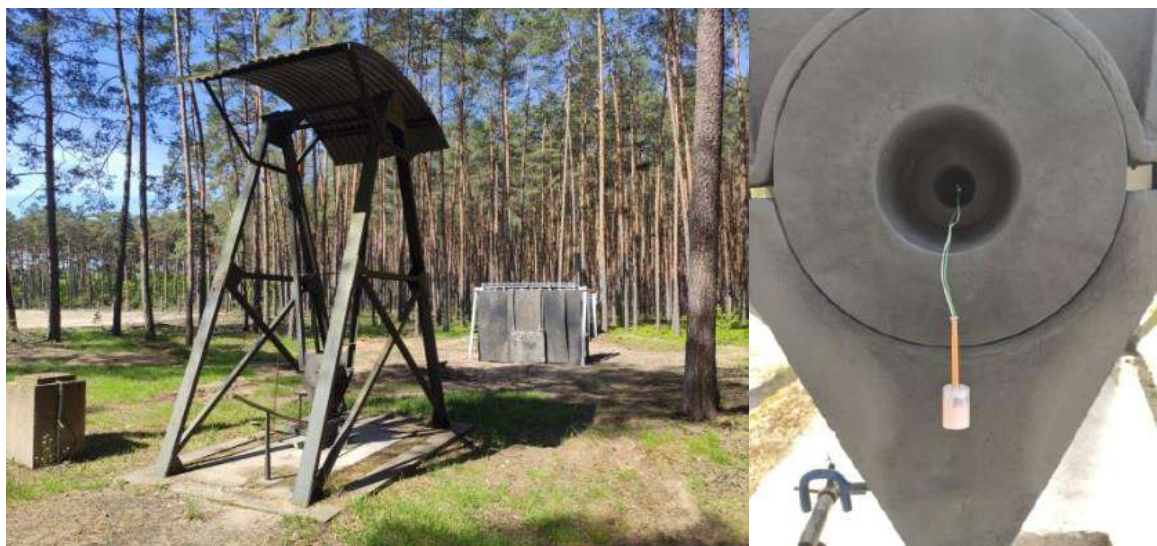
Rysunek 7. Wygląd stanowiska do oznaczania względnej zdolności wykonania pracy.
