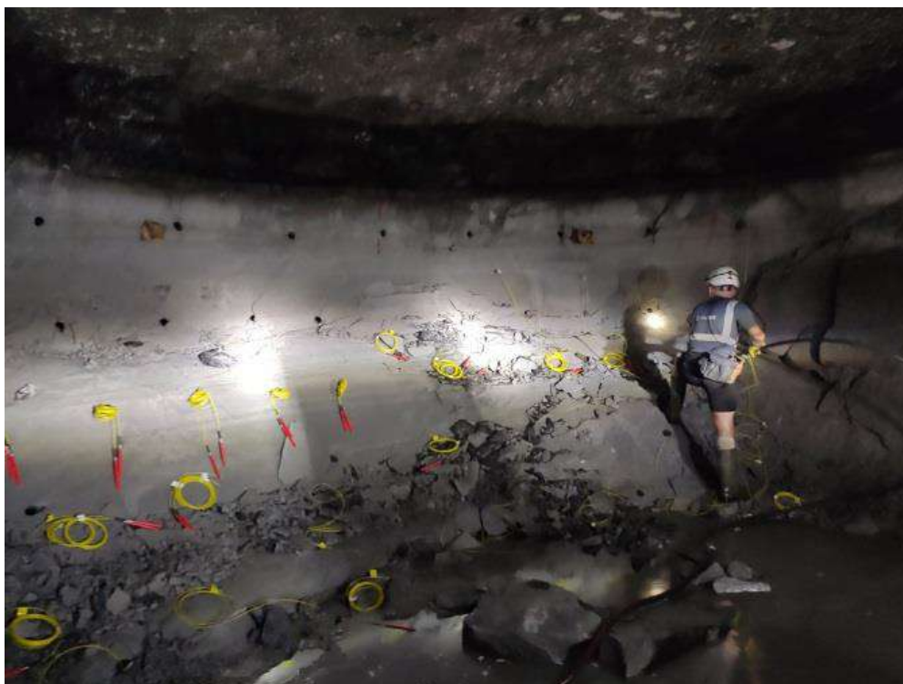
Rysunek 17. Załadunek otworów strzałowych w kopalni.
