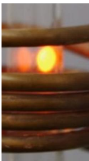
Rysunek 9.1: Geometria wsadu po przekroczeniu temperatury topnienia dla 650 A.
