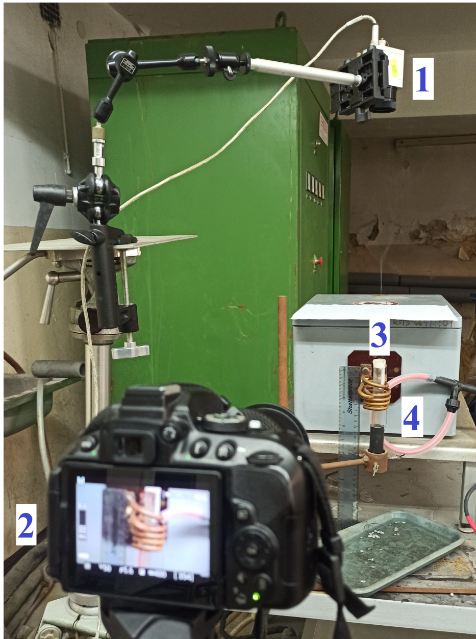
Rysunek 6.1: Stanowisko używane do pomiaru pozycji i temperatury wsadu oraz parametrów elektrycznych. Opis oznaczeń znajduje się w tekście.
