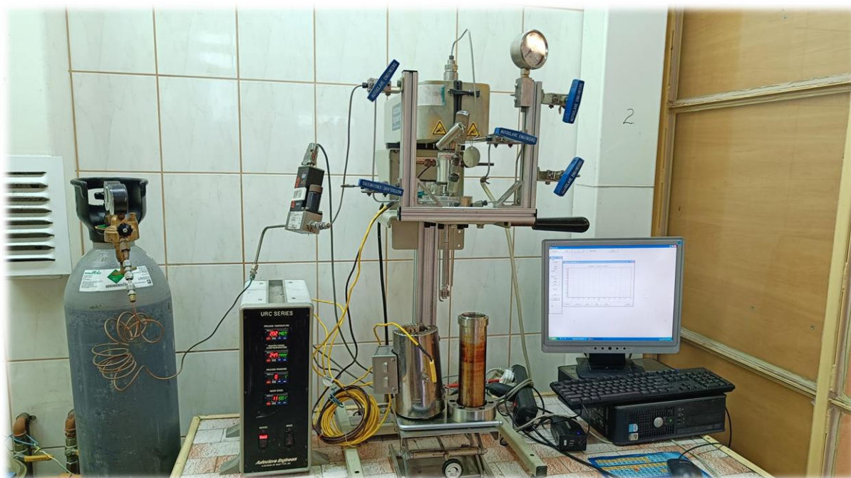
Rysunek 56. Reaktor ciśnieniowy American Engineers z naczyniem reakcyjnym o pojemności 300 ml
