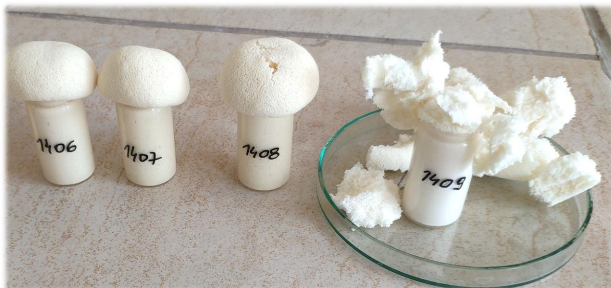
Rysunek 37. Próby spieniania NIPU za pomocą mikrosfer Expancel 093DU120
