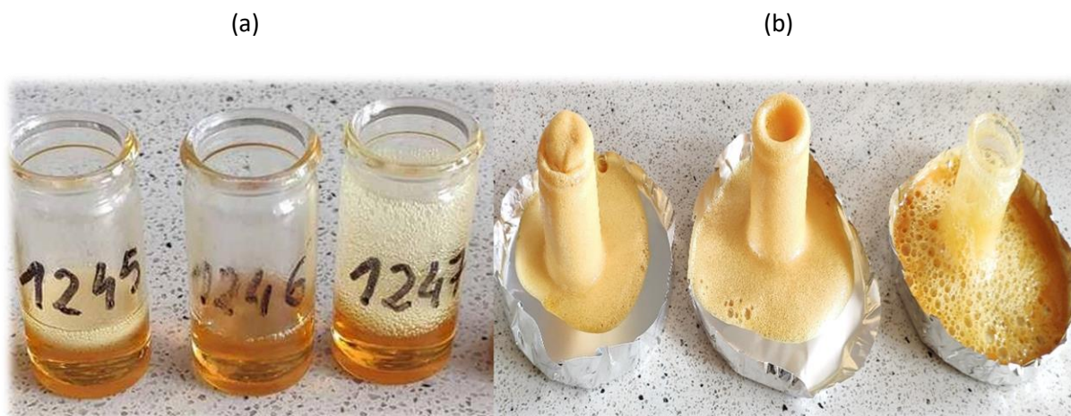
Rysunek 36. Próby spieniania NIPU za pomocą pentanu (a) oraz AZO/ZnO (b)
