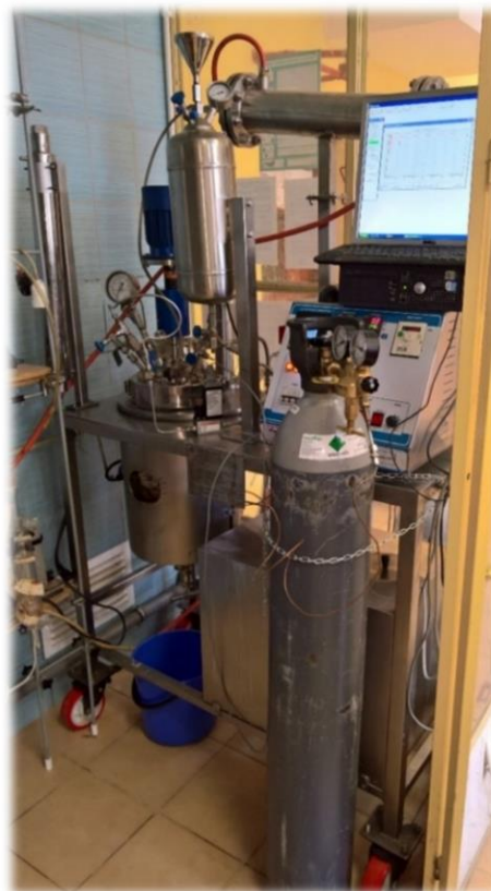
Rysunek 57. Reaktor ciśnieniowy Amar Equipments z naczyniem reakcyjnym o pojemności 15 litrów
