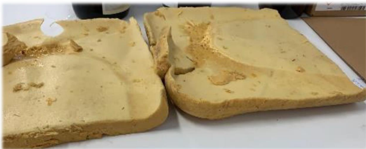
Rysunek 46. Piany NIPU otrzymane z zastosowaniem maszyny spieniającej SAIP S100
