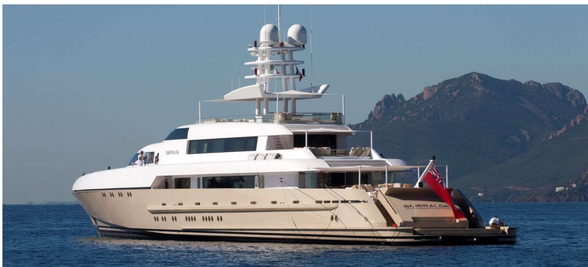
Rys. 30. Jacht Smeralda zbudowany ze m.in. ze stopu aluminium EN AW-6082 przez australijską firmę SilverYachts [79]
