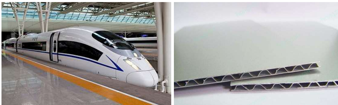
Rys. 29. Pociąg ekspresowy Harmony CRH3 w Chinach zbudowany z paneli ściennych i podłogowych ze stopu aluminium EN AW-6082 [76]
