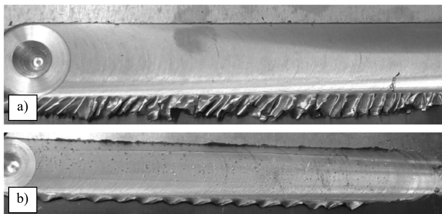
Rys. 44. Widok powierzchni lica zgrzeiny wykonanej z zastosowaniem wieńca opory o kształcie powierzchni: a) wklęsłej, b) helisoidalnej [83]
