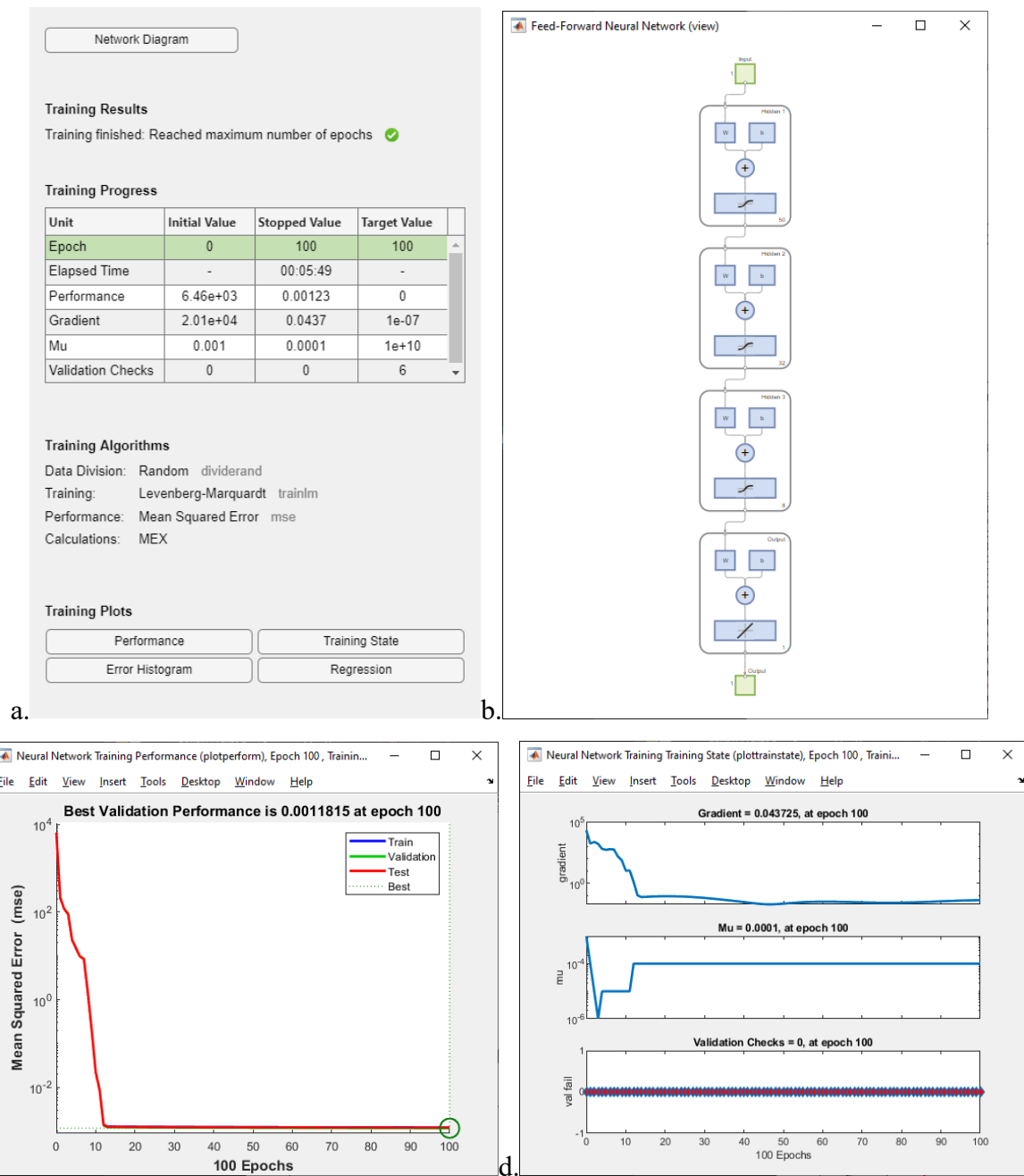
Rys. 23. Parametry treningu sieci neuronowej (a), struktura modelu sieci neuronowej (b), przebieg funkcji błędu (MSE) podczas uczenia sieci (c), stan procesu uczenia sieci neuronowej (d)
