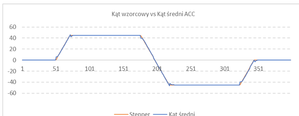
Rys. 17. Wykres kąta wzorcowego silnika krokowego (stepper) oraz uśrednionego kąta wyznaczonego po zastosowaniu poprawek na bazie regresji liniowej.
