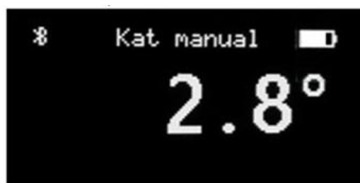
Rys. 80. Ekran pomiarowy, który wskazuje, że urządzenie jest gotowe do pracy oraz, że została nawiązywana komunikacja bezprzewodowa Bluetooth z aplikacją komputerową.
