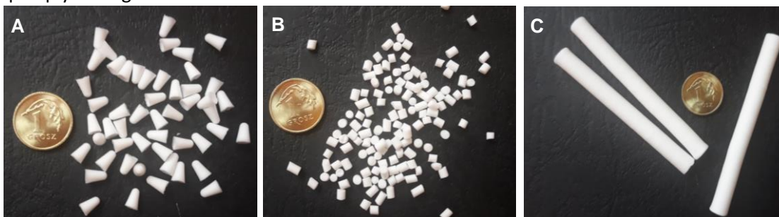
Rys. 16 Monolity krzemionkowe w formie paciorków (A), walców (B) lub rdzenia do mikroreaktora (C)
