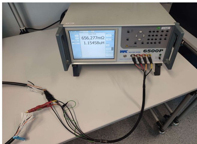
Rys. 15. Fotografia stanowiska pomiarowego do badania parametrów przewodów komunikacyjnych podczas badań wstępnych. Do połączenia obiektów badanych do przyrządu pomiarowego wykorzystano adapter 1EVA40100 [114].
