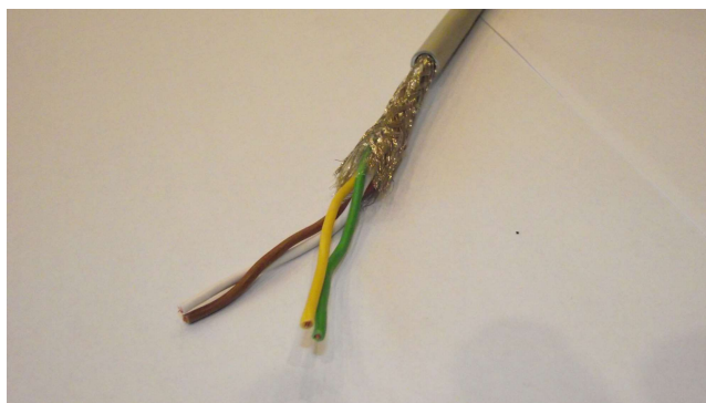
Rys. 11. Widok ogólny przewodu Typ 3 CY 2 \times 2 \times 1,0\text{mm}^2 .
