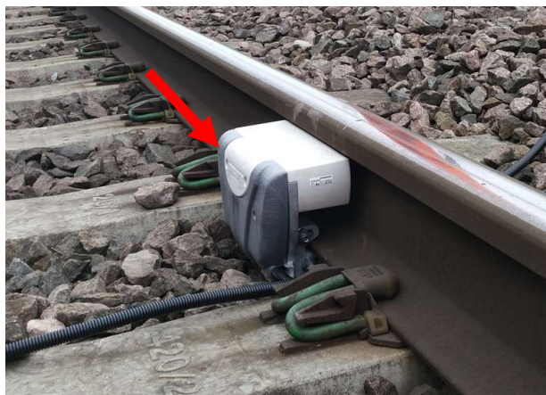
Rys. 6. Czujnik koła ELS-96 (urządzenie przytorowe), głowica zintegrowana: detekcja oraz elektronika w jednej obudowie. (Fot. ALSTOM ZWUS)
