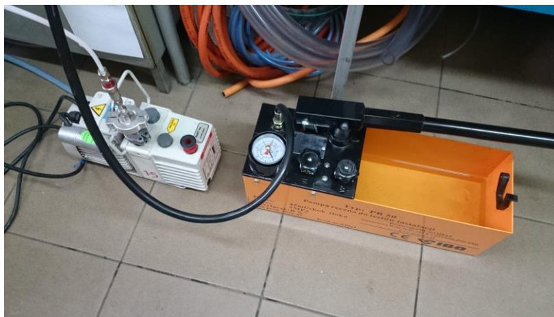
Rys.5.11. Pompa próżniowa (po lewej) oraz ręczna pompa wody utrzymująca próbkę (po prawej).
