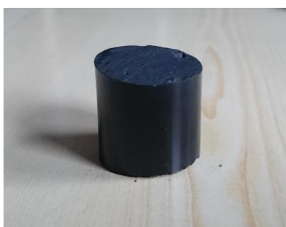
Rys.6.22a. Żywica epoksydowa z grafitem przed ściskaniem.
