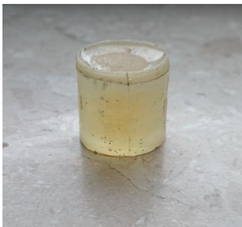
Rys.6.21a. Żywica epoksydowa przed ściskaniem.
