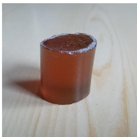
Rys.6.23a. Żywica poliestrowa przed ściskaniem.
