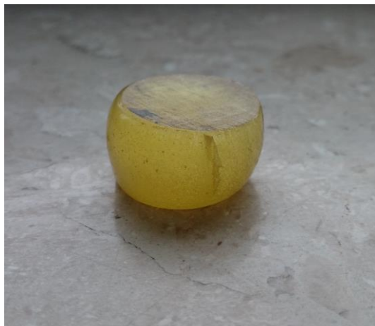
Rys.6.21b. Żywica epoksydowa po ściskaniu.
