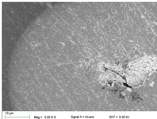
Rys.6.17b. Żywica epoksydowa Epidian 5 z utwardzaczem Z1 z domieszką popiołu (30% obj.) – powiększenie.
