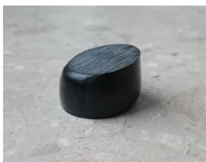
Rys.6.22b. Żywica epoksydowa z grafitem (5% obj.) po ściskaniu.
