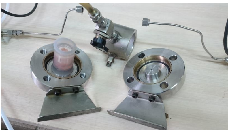
Rys.5.8. Holder utrzymujący próbkę.
