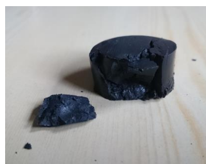
Rys.6.22c. Żywica epoksydowa z grafitem (30% obj.) po ściskaniu.
