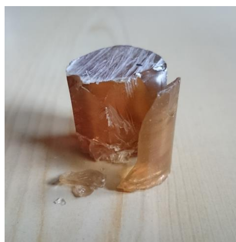
Rys.6.23b. Żywica poliestrowa po ściskaniu.
