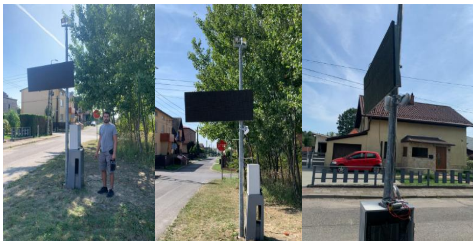
Rysunek 101. Prototyp systemu zwiększającego bezpieczeństwo niechronionych uczestników ruchu drogowego – testy systemu w warunkach rzeczywistych
