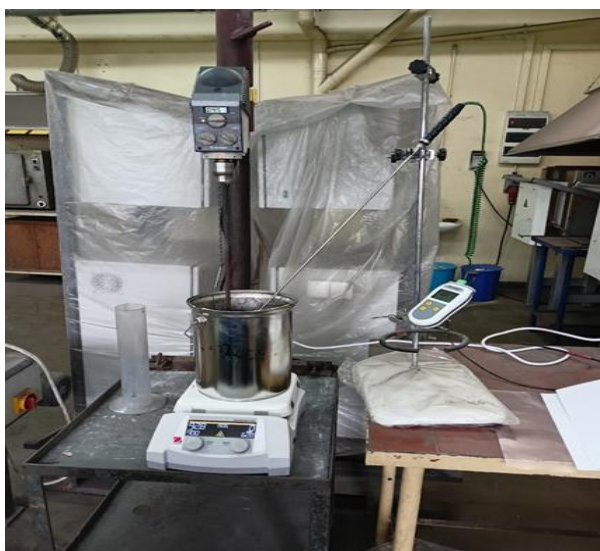
Rys. 45. Widok stanowiska badawczego procesu odseparowania żelu hydrofobowego za pomocą gorącej wody.
