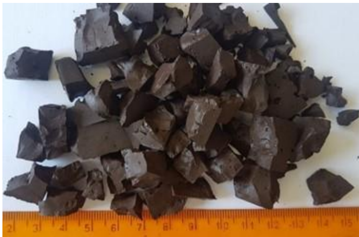
Rys. 102. Spoiwo geopolimerowe z wełny mineralnej z dodatkiem boksytu (SG_B), forma rozdrobniona [13]
