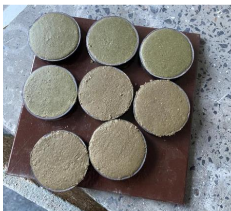
Rys. 87. Próbkki do badania współczynnika przewodności cieplnej [187]
