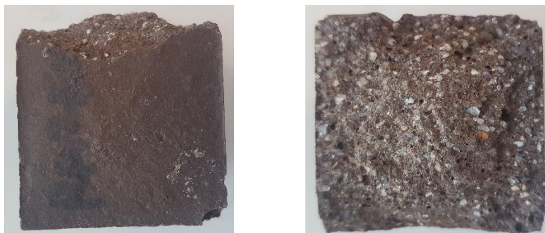
Rys. 104. Zaprawa geopolimerowa z wełny mineralnej z dodatkiem boksytu (ZG_B), forma monolityczna [13]
