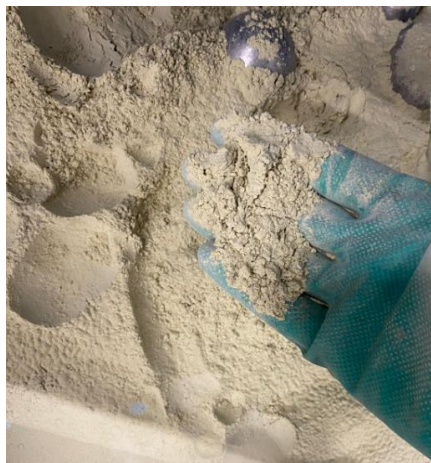
Rys. 71. Urobek mielenia wełny szklanej w młynie kulowym typu Los Angeles
