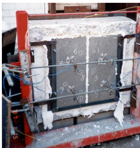
Rys. 32. Fragment panelu geopolimerowego podczas testów ognioodporności [120]
