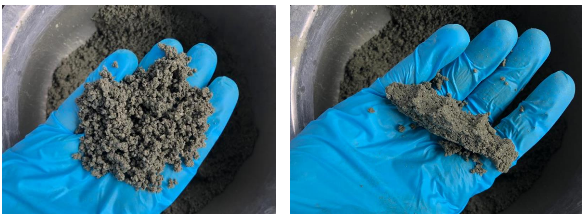
Rys. 40. Zaprawa geopolimerowa na bazie wełny mineralnej [materiały własne]
