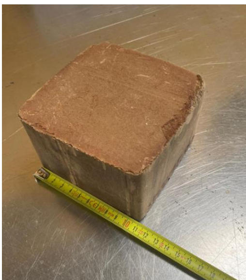
Rys. 46. Brykiet na bazie spoiwa geopolimerowego wykorzystany w próbach przemysłowych przy produkcji wełny mineralnej
