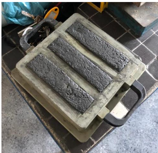
Rys. 41. Zaprawa geopolimerowa w formie trójdzielnej o wymiarach 40x40x160 mm
