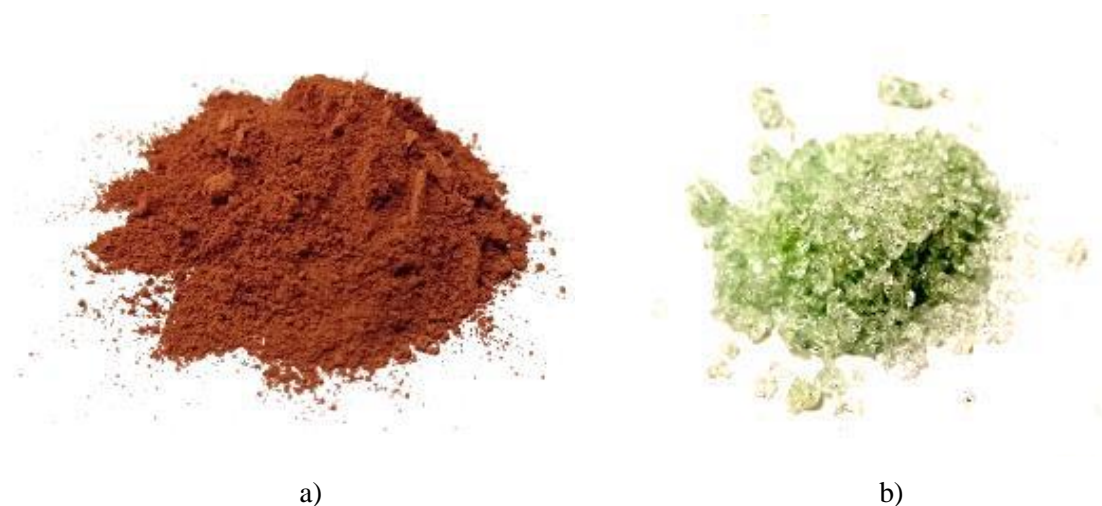
Rys. 48. Wytypowane materiały dodane do procesu mielenia: a) boksyt, b) stłuczka szklana [175]
