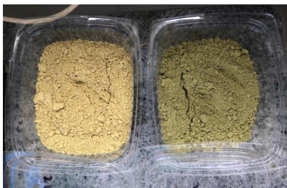
Rys. 73 Uzyskany urobek zmielonej wełny szklanej (WS1) i mineralnej (WM1)
