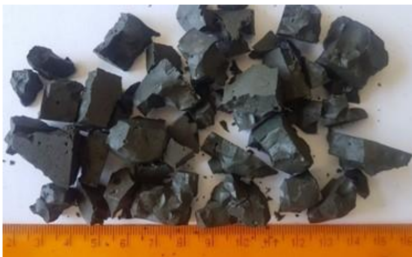
Rys. 103. Spoiwo geopolimerowe z wełny mineralnej z dodatkiem \text{Al}_2\text{O}_3 (SG_ \text{Al}_2\text{O}_3 ), forma rozdrobniona [13]
