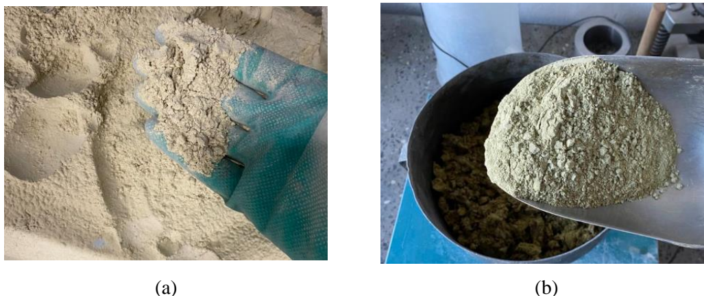
Rys. 75. Wełna mineralna po zmieleniu: (a) wewnątrz młyna kulowego; (b) przed zmieszaniem z zaprawą [180]
