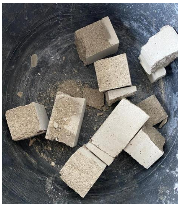
Rys. 108. Próbki zapraw przygotowane do badania wymywania [180]
