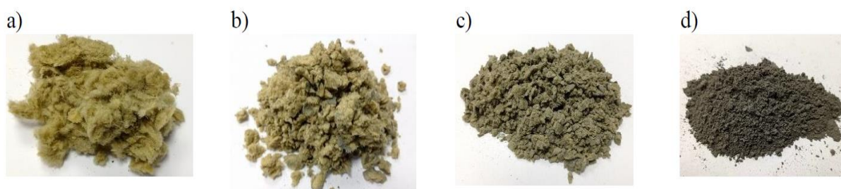
Rys. 51. Rezultat rozdrabniania wełny mineralnej przez a) 0, b) 5, c) 15 i d) 25 minut [175]
