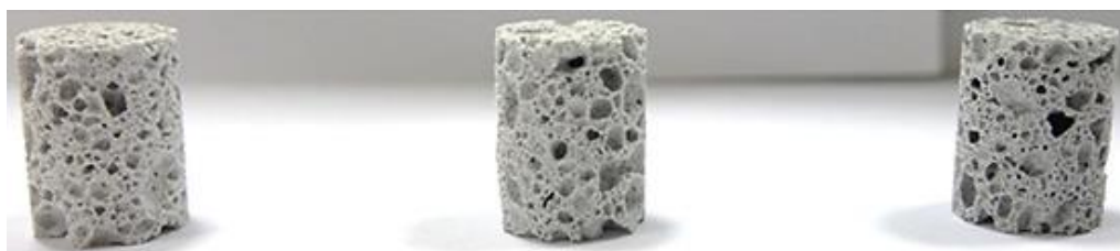
Rys. 28. Spieniony geopolimer z dodatkiem mączki szklanej [129]
