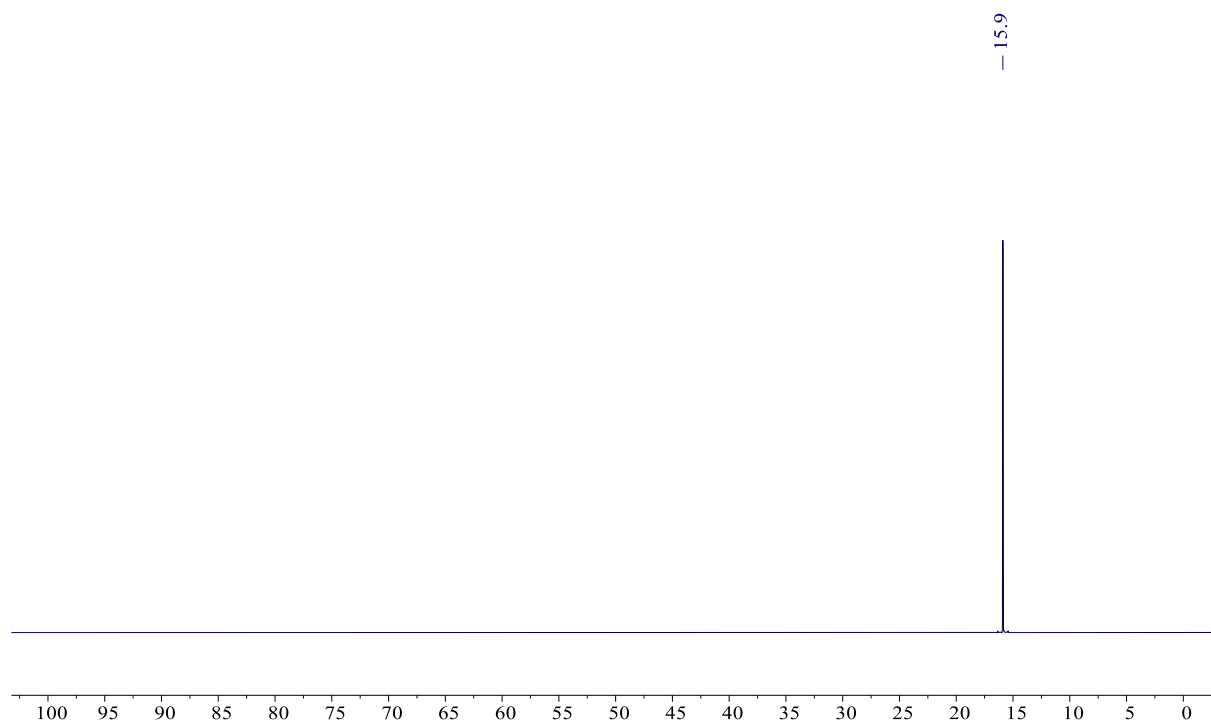
Rys. 54. Widmo ^{31}\text{P} NMR koniugatu 1-aminometylideno-1,1-bisfosfonianu tetraetylu z indometacyną 20 ; 162 MHz/ \text{CDCl}_3/\delta (ppm) względem sygnału \text{H}_3\text{PO}_4
