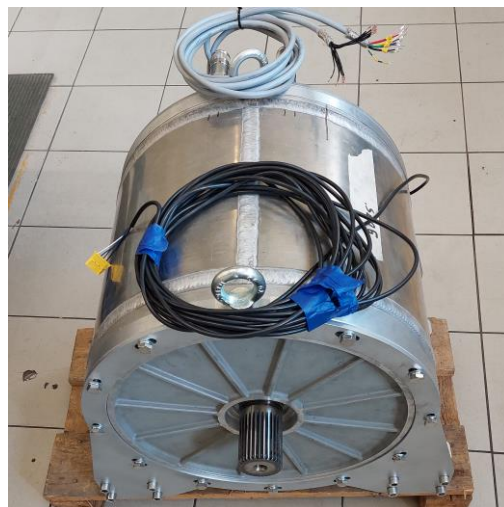
Rys. 97. Pakiet stojana uzwojony i wprasowany w kadłub oraz kompletny silnik SMwsK280M16B
