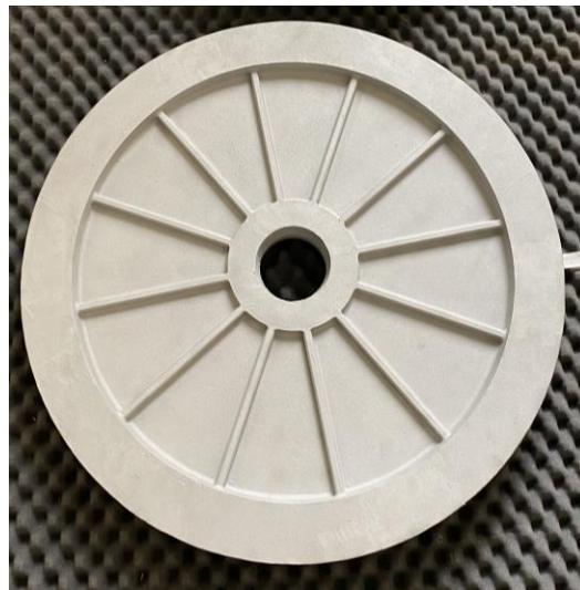
Rys. 96. Przygotowany kadłub do obróbki mechanicznej i tarcza łożyskowa od strony D
