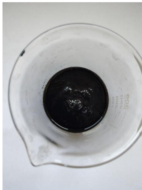
Zdjęcie 4.5. Wynik próby dyspersji nanorurek węglowych z udziałem SDS.
