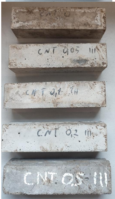
Rysunek 4.99. Inspekcja wizualna próbek zapraw o normowym stosunku piasek-cement po ekspozycji w środowisku ściekowym. a) – osad czynny, b) osad czynny z dodatkową pożywką, c) osad fermentacyjny, d) seria kontrolna
