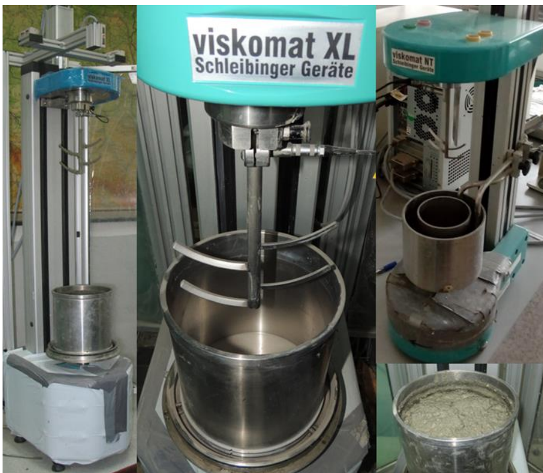
Rys. 54. Reometry XL i NT używane w badaniach właściwości reologicznych mieszanek betonowych (Blok 1-III) i mieszanek zapraw (Blok IV)
