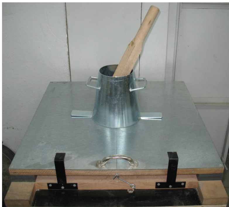
Rys. 53. Zestaw do badania konsystencji mieszanek betonowych według PN-EN 12350-5, widoczny stolik z uchylną płytą o wymiarach 70x70cm, drewniany ubijak o przekroju 40x40mm i metalowy stożek ścięty o wysokości 20 cm.
