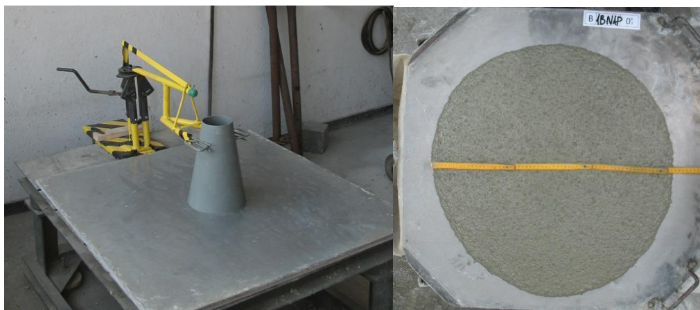
Rys. 52. Stanowisko do badania rozplýwu mieszanek wg PN-EN 12350-8, rozplýw mieszanki BSZ po lewej
