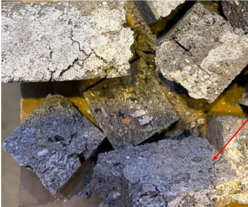
Rysunek 102 Próbkę po sezonowaniu w wodzie i próbach zamrażania-rozmrażania. Opracowanie własne.
