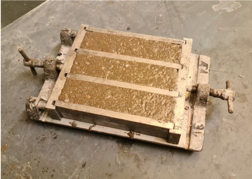
Rysunek 37 Przygotowana próbka w formie trójdzielnej. Opracowanie własne
