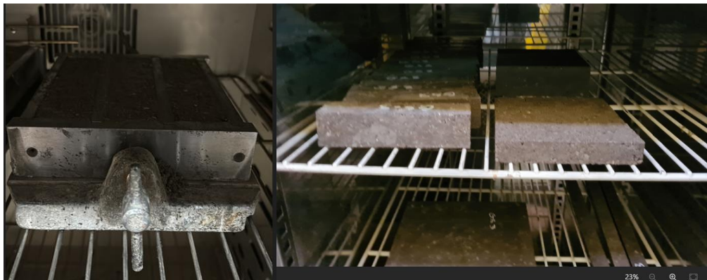
Rysunek 38 Próbka w formie trójdzielnej i beleczki e sezonowana w suszarce. Opracowanie własne
