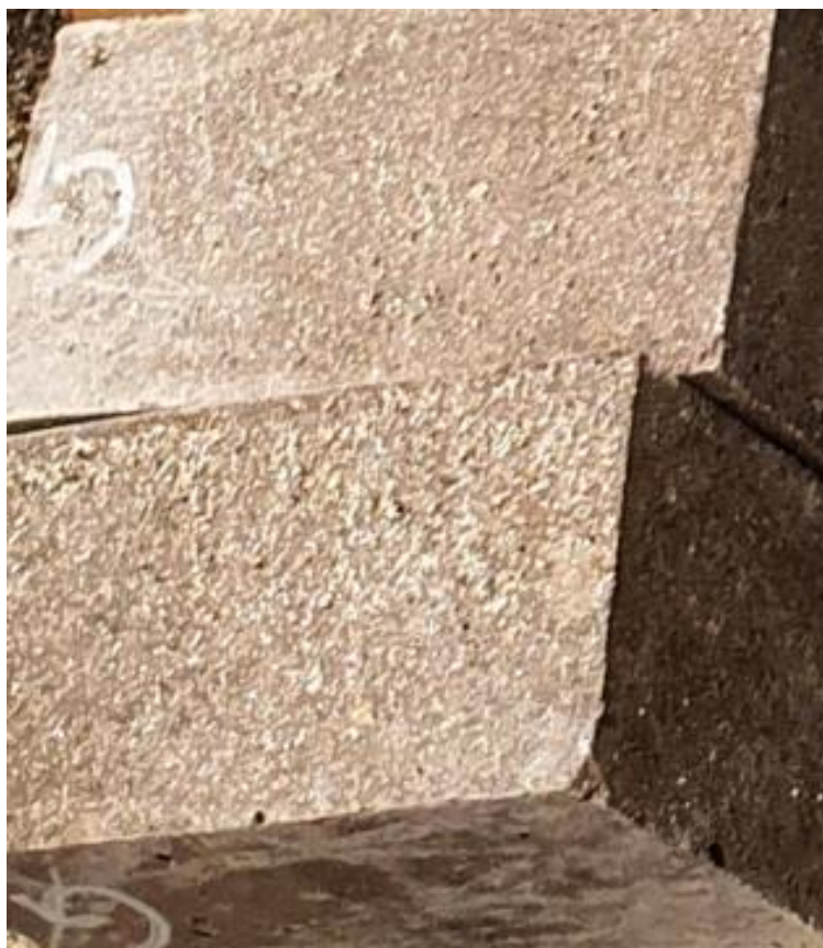
Rysunek 41 Tekstura beleczek wytworzonych z popiołu z elektrowni Łagisza, kompozycja T1-2/Ł. Opracowanie własne.
