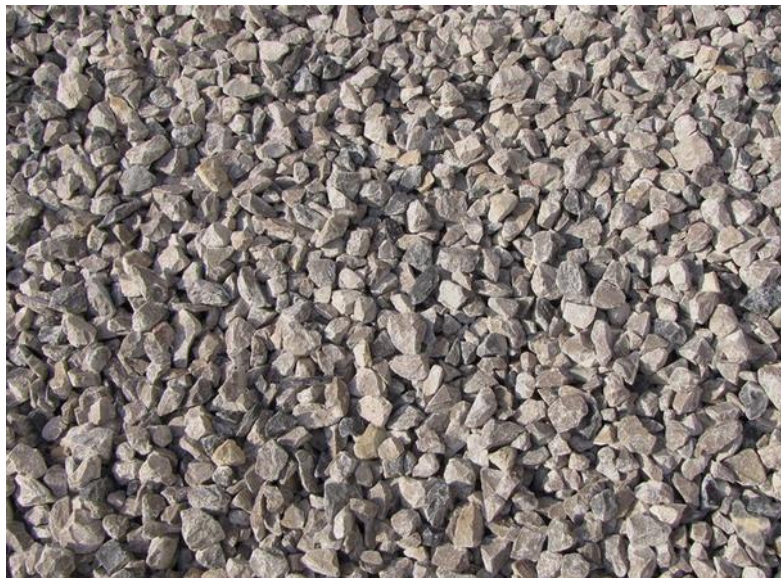
Rysunek 21 Grys wapienny 2-8mm z Kopalni Wapienia Czatkowice. Opracowanie własne
