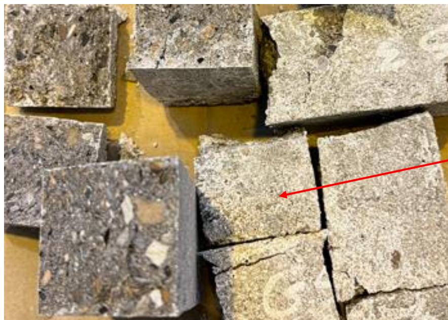
Rysunek 91 Próbki po badaniach niszczących, sezonowane w roztworze H_2SO_4 . Opracowanie własne.
