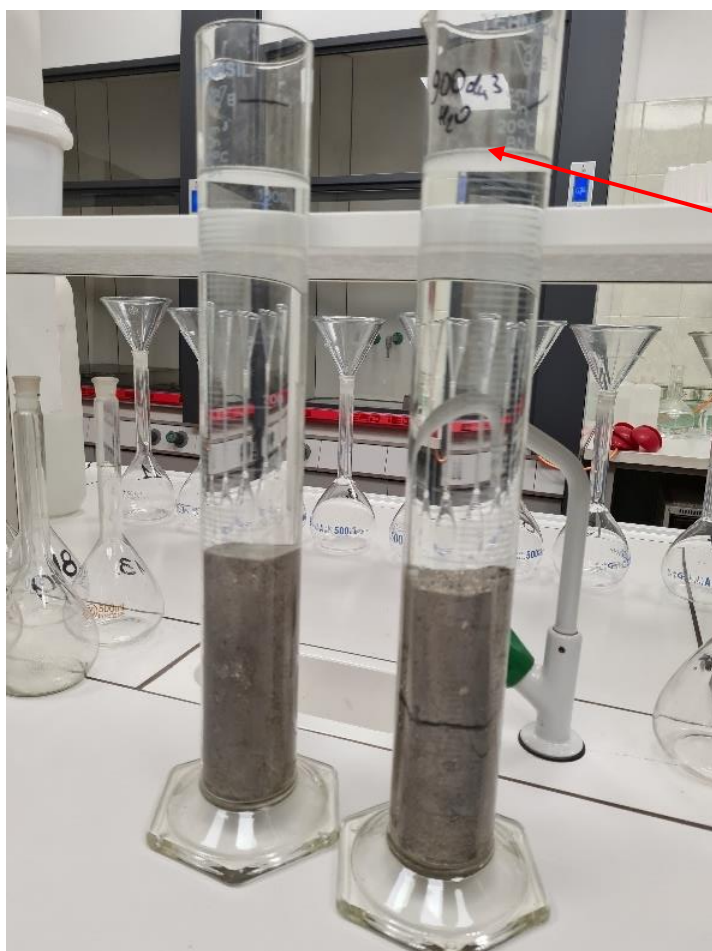
Rysunek 106 Sezonowanie próbek w wodzie zdeminielizowanej. Opracowanie własne
