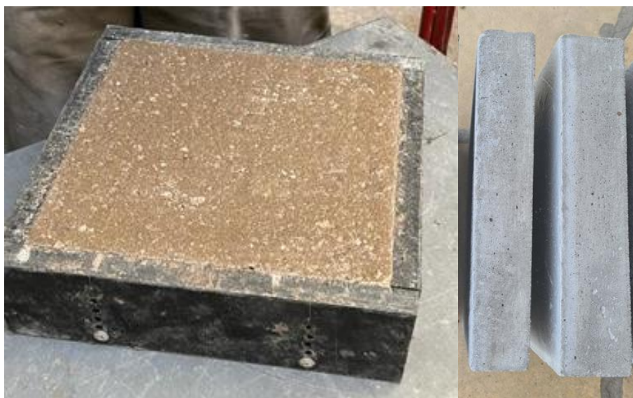
Rysunek 39 Formowanie płytki z polimerobetonu oraz gotowe płytki wykonane z betonu cementowego do badań własności wibroakustycznych. Opracowanie własne
