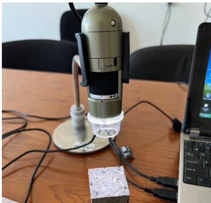
Rysunek 89 Stanowisko do badania przełomów próbek polimerobetonowych. Opracowanie własne
