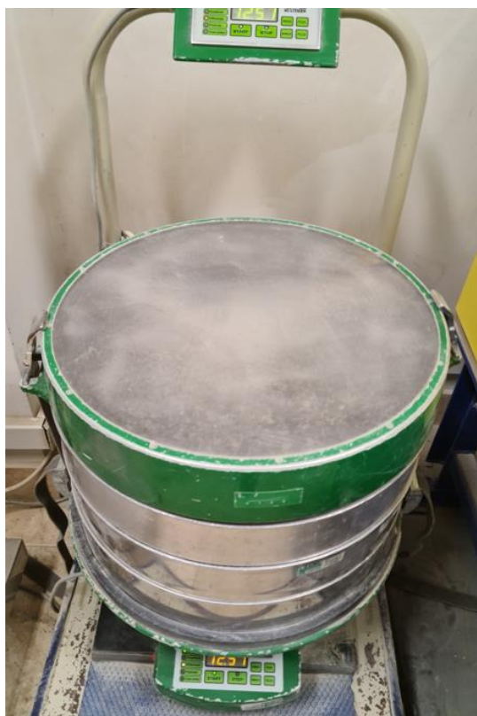
Rysunek 23 Laboratoryjny przesiewacz wibracyjny Muliserw. Opracowanie własne
