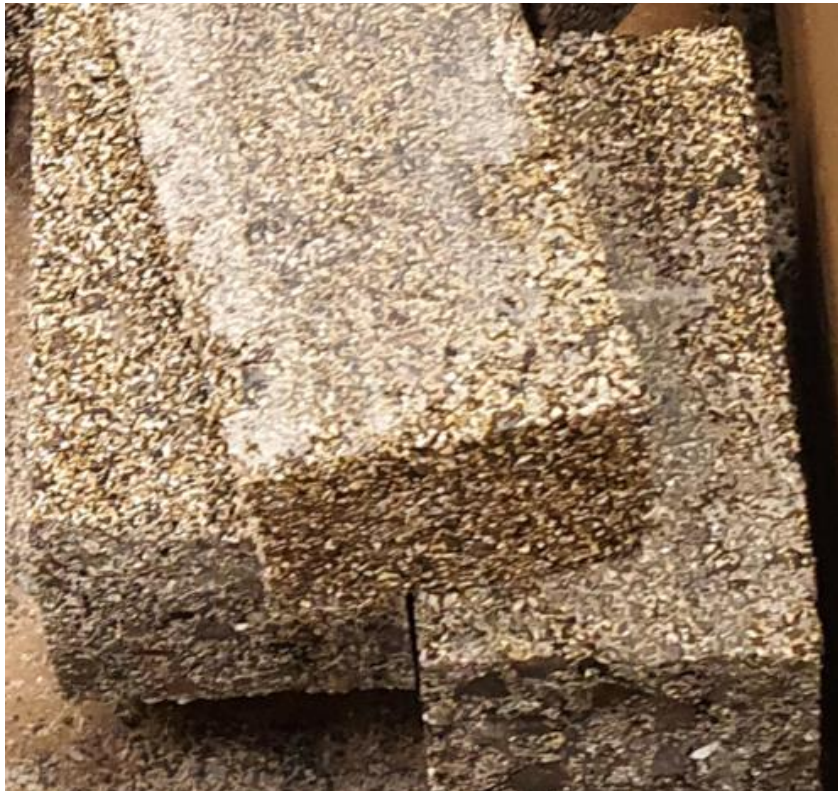
Rysunek 40 Tekstura "piaskowa" beleczek wytworzonych z popiołu z elektrowni Jaworzno II, kompozycja T1-1/J. Opracowanie własne
