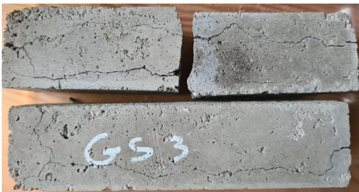
Rysunek 101 Próbkki sezonowane w wodzie po czterech cyklach zarażania – widok od góry i z boku. Opracowanie własne.
