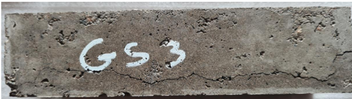
Rysunek 100 Próbkki sezonowane w wodzie po czterech cyklach zarażania – widok od (a) przodu i z (b) boku. Opracowanie własne.
