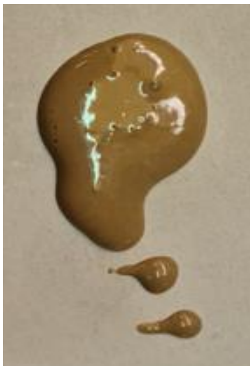
Rysunek 34 Żywica z mikrowypełniaczem wapiennym. Opracowanie własne
