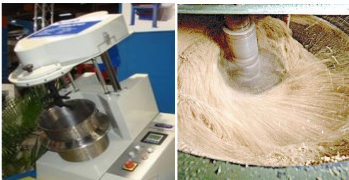
Rysunek 35 Laboratoryjny mieszalnik intensywny. Proces mieszania. Źródło [99]
