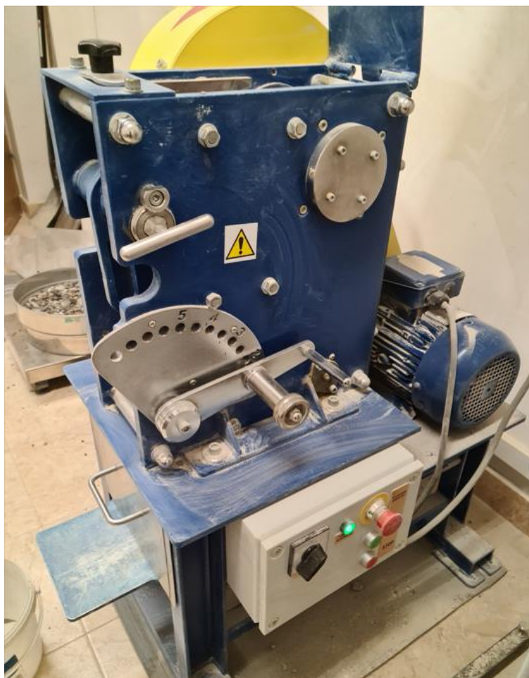
Rysunek 24 Laboratoryjna kruszarka szczękowa LAB-02-130. Opracowanie własne
