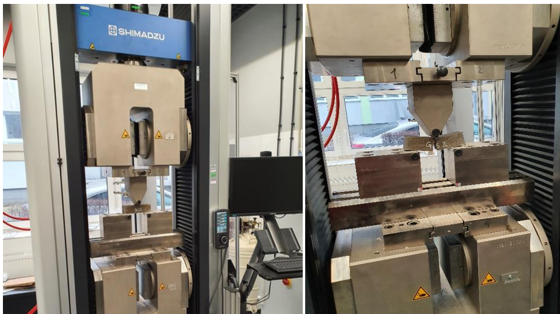
Rysunek 45 Test trójpunktowego zginania na maszynie wytrzymałościowej. Opracowanie własne
