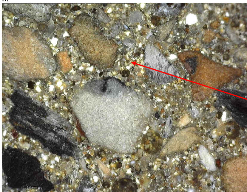
Rysunek 90 Obrazy makroskopowe struktur przełomu badanych polimerobetonów (a – i). Opracowanie własne.
