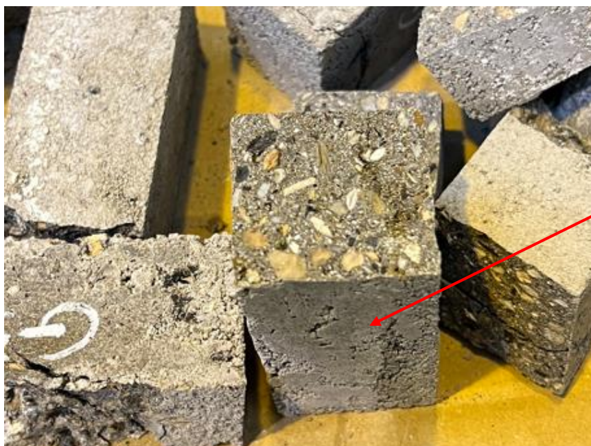
Rysunek 97 Próbkę po badaniach niszczących, sezonowane w roztworze NaCl. Opracowanie własne
