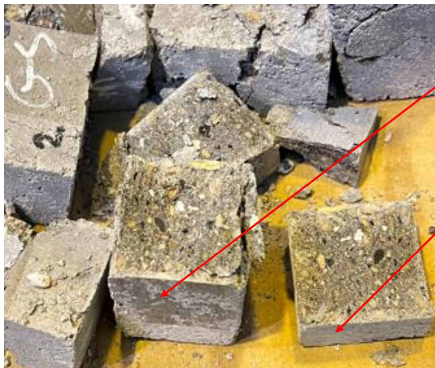
Rysunek 94 Próbkki po badaniach niszczących, sezonowane w roztworze NaOH. Opracowanie własne
