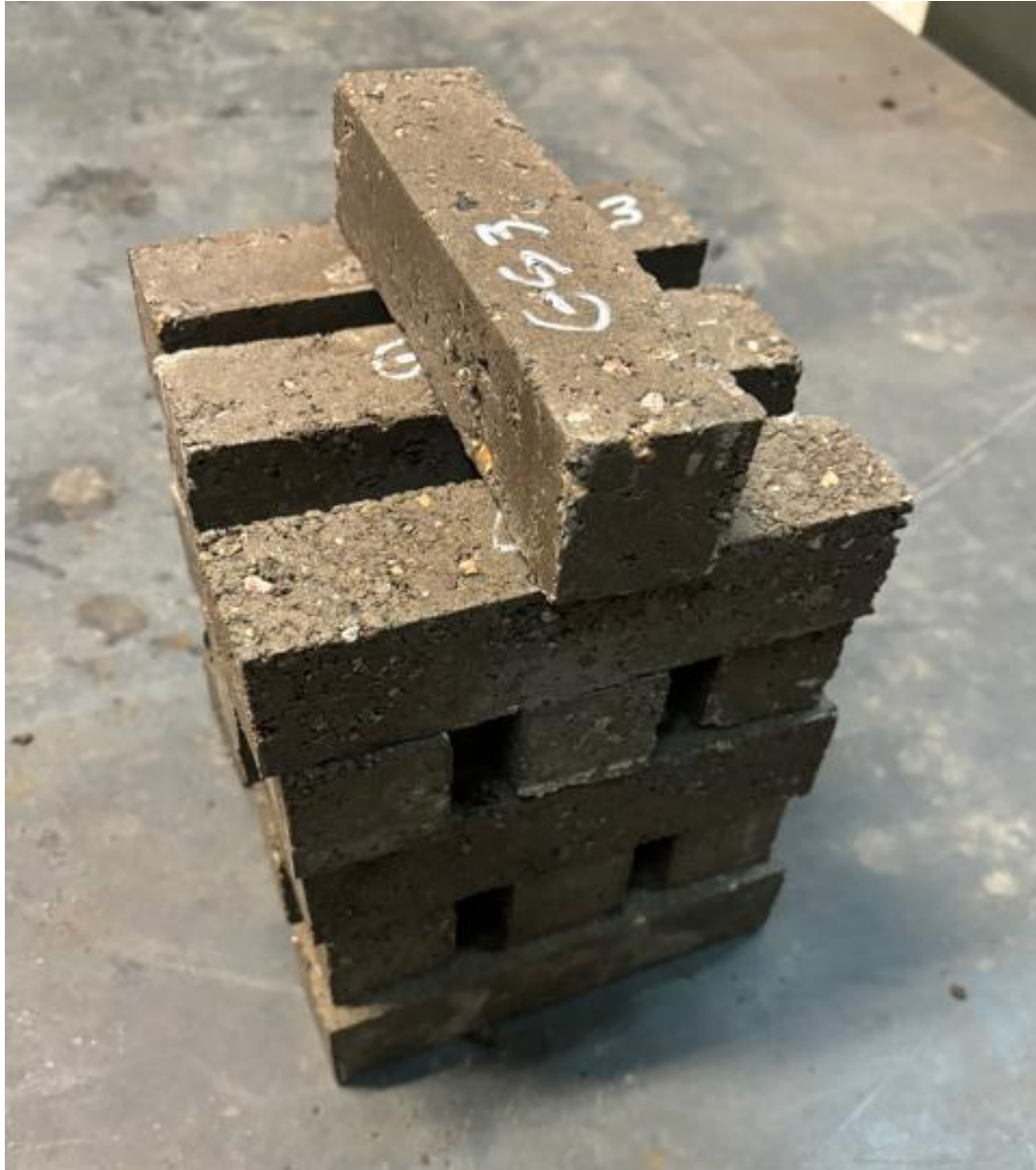
Rysunek 43 Próbki wytworzone wg. kompozycji wypełnienia T2-3/Ł dla testu nr 3. Opracowanie własne
