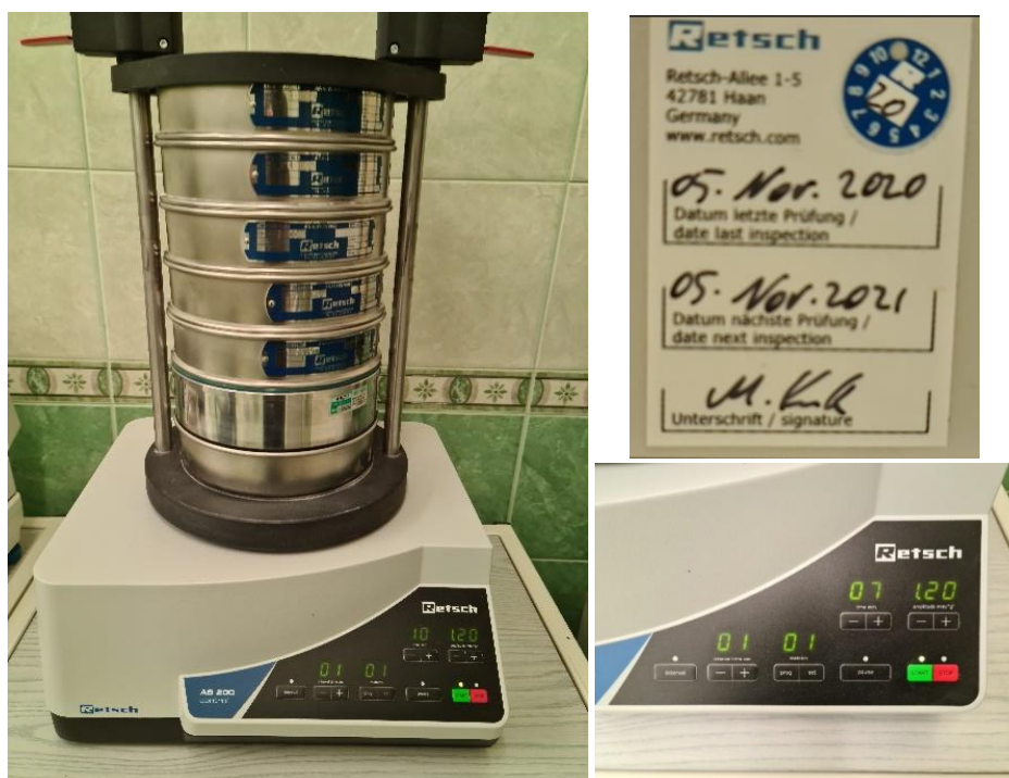
Rysunek 14 Przesiewacz laboratoryjny Retsch AS 200. Opracowanie własne
