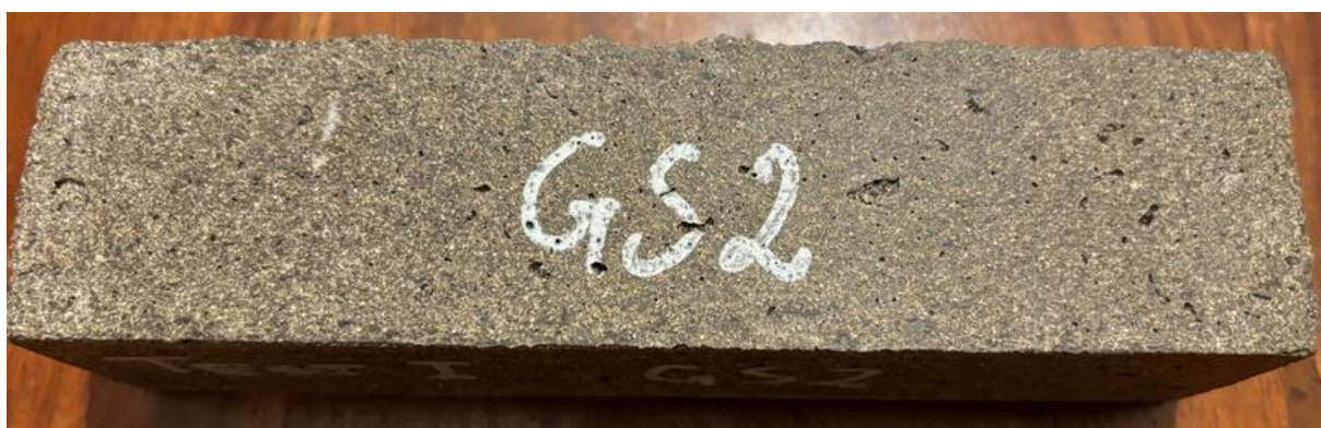
Rysunek 105 Próbką sucha po czterech cyklach zamrażania-rozmrażania. Opracowanie własne.
