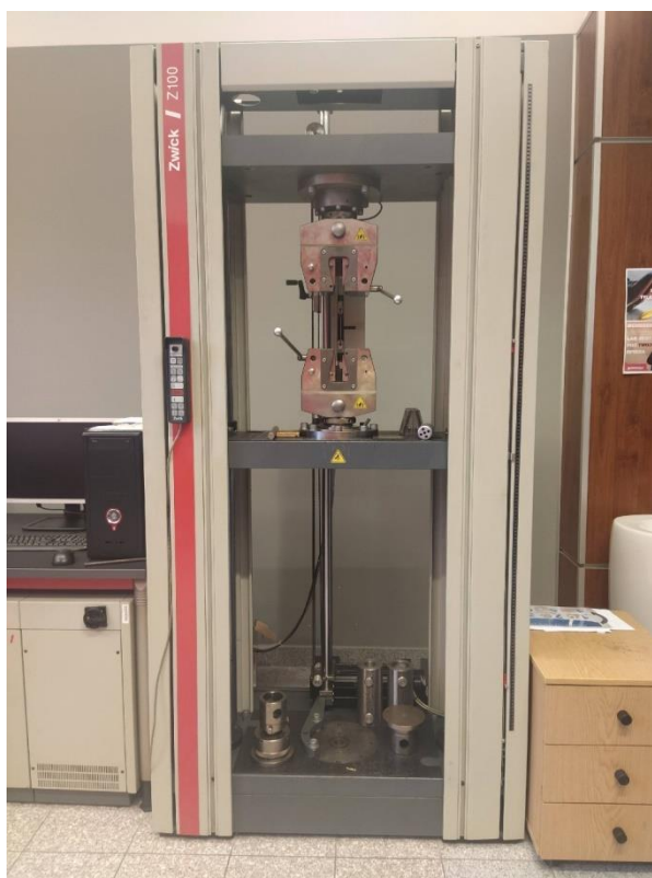
Rysunek 10. Maszyna wytrzymałościowa do statycznej próby rozciągania - Laboratorium Badania Materiałów, Wydział MT, Politechnika Śląska (opracowanie własne).
