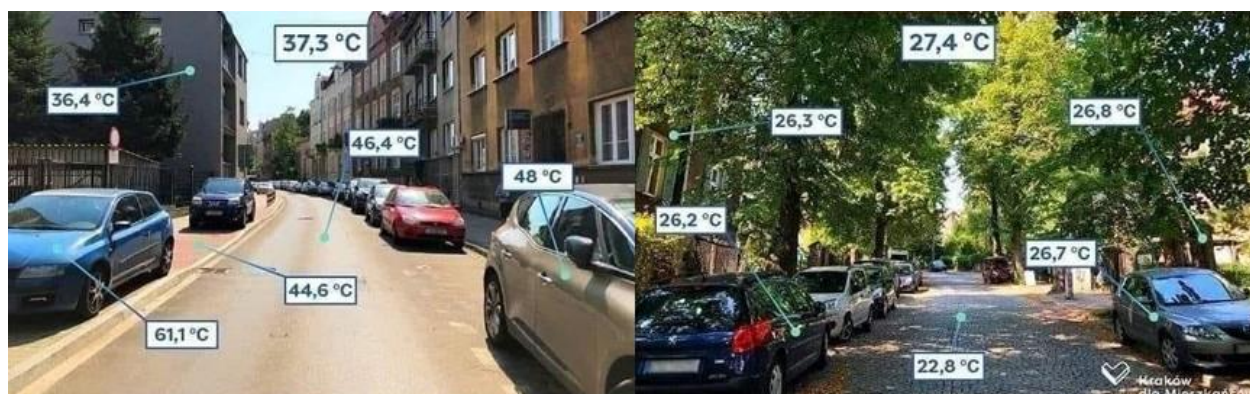
Rysunek 37 Schematyczne porównanie różnic temperatur na ulicy bez drzew i na ulicy z drzewami, źródło: @Kraków dla Mieszkańców
