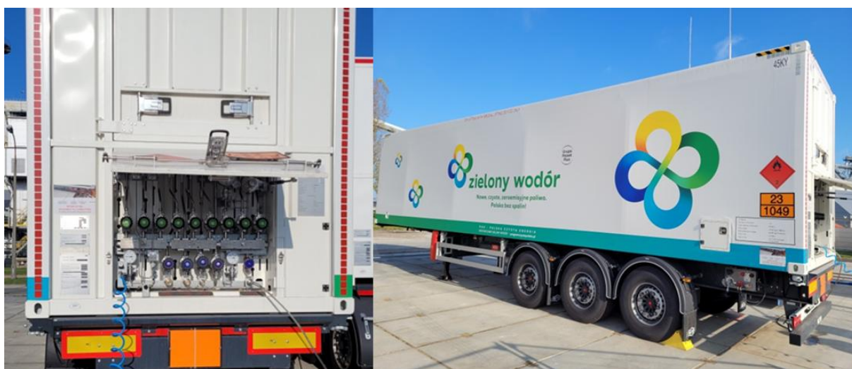
Rys. 14. Mobilny magazyn wodoru. Widok na część przyłączeniową (po lewej) oraz profil boczny (po prawej) [Źródło: zdjęcia udostępnione przez elektrownię]
