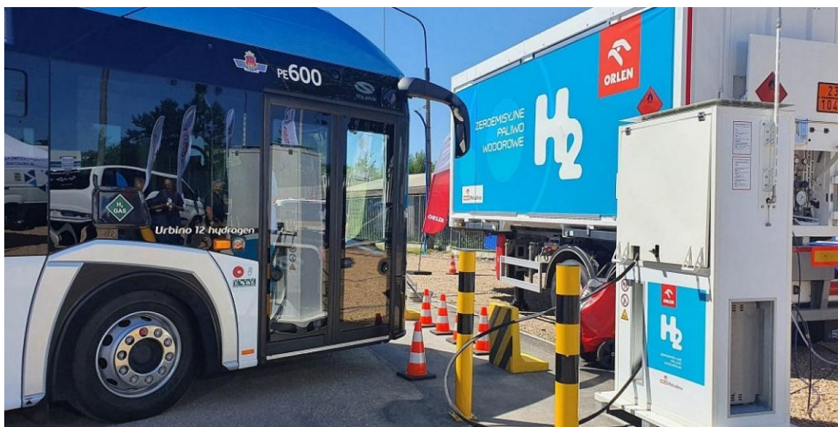
Rys.8. Proces tankowania pojazdu wodorem za pomocą mobilnej stacji [65].
