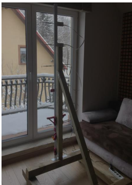
Rys. 5.8. Stanowisko do pomiarów pionowego rozkładu prędkości powietrza wewnętrznego w pomieszczeniu
